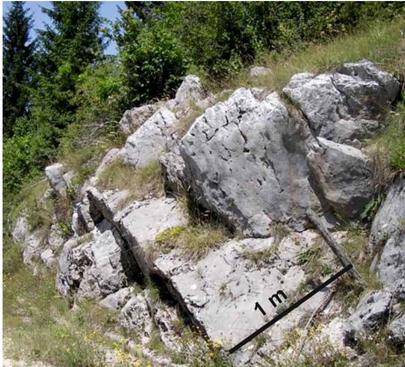
Slika 5.19. Strmo nagnuti srednje do deblje slojeviti vapnenci litostratigrafske jedinice Milna sa smjerom nagiba slojevitosti prema sjeveroistoku u zasjeku makadamske ceste Račja Vas–Veprinac ( 45^{\circ}23'59.4''\text{N} , 14^{\circ}9'52.9''\text{E} ).
