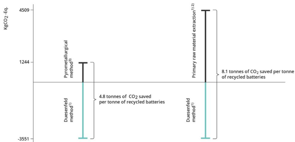
Slika 15. Ušteda CO<sub>2</sub> u usporedbi s pirometalurškom metodom i primarnom ekstrakcijom
