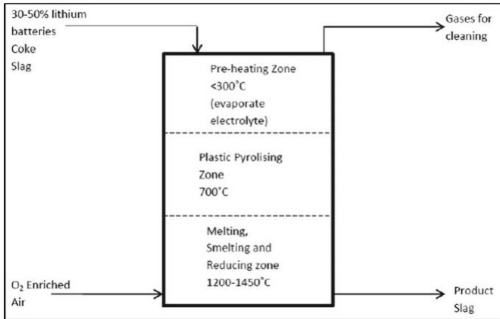
Slika 12. Temperaturne zone peći IsaSmelt™ postrojenja Umicore
