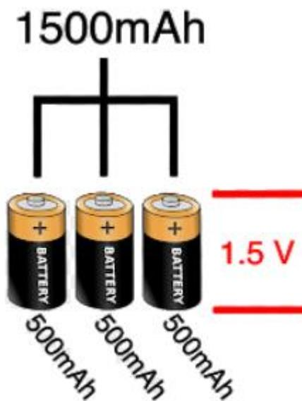
Slika 6. Paralelni spoj baterija
