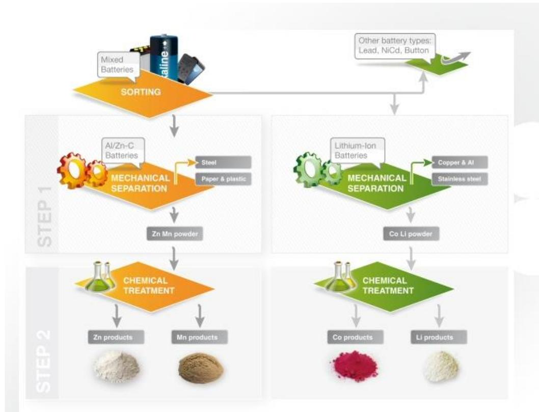
Slika 11. Proces recikliranja baterija u postrojenju Recupyl
