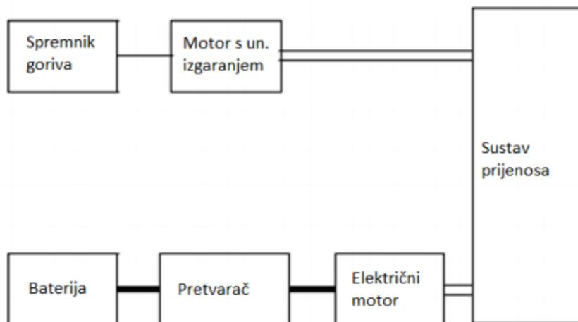
Slika 4. Shematski prikaz komponenti paralelnog HEV-a
