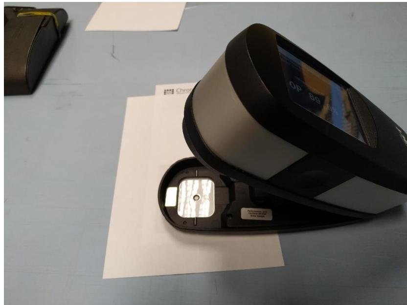
**Slika 5-5** Ispitivanje neprozirnosti
