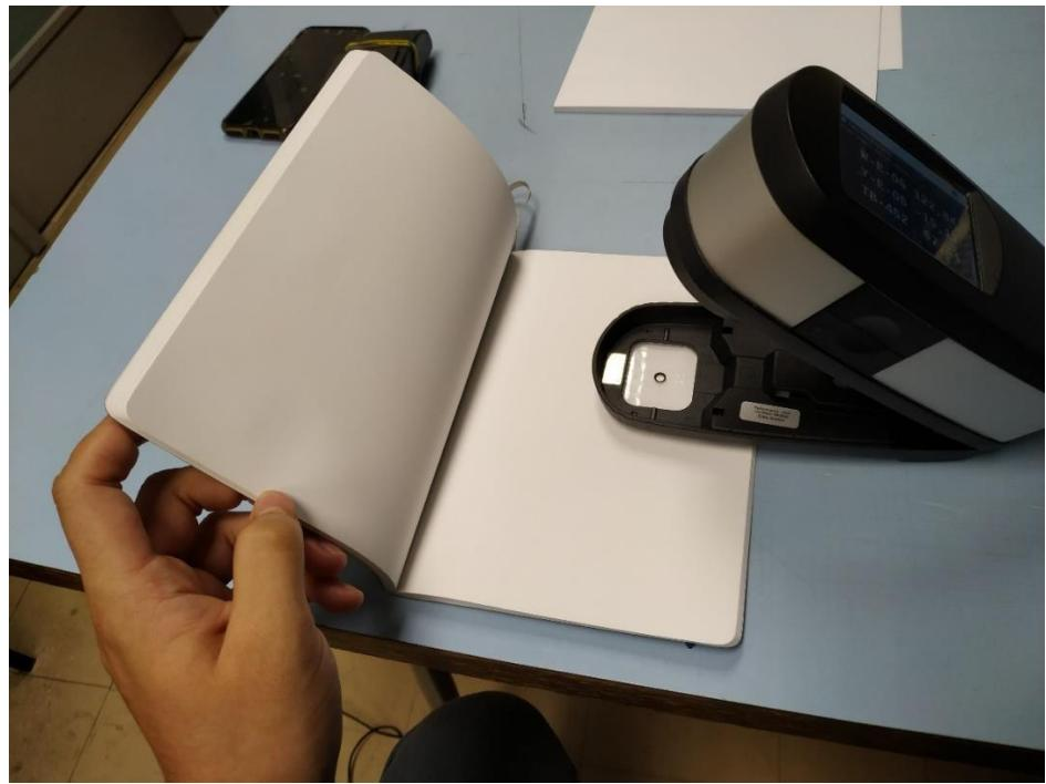
Slika 5-3 Ispitivanje na mineralnom papiru
