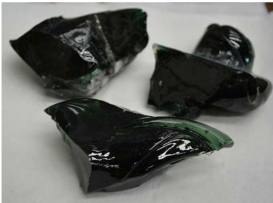
Slika 2-3 Vitrificirani VRAO (British Glass, 2019)
