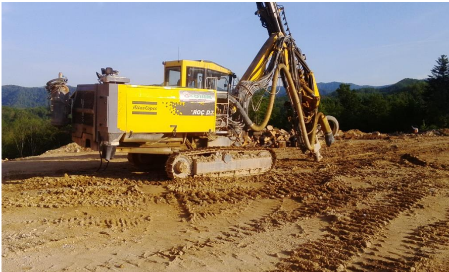
Slika 5-7. Bušilica Atlas Copco ROC D7
