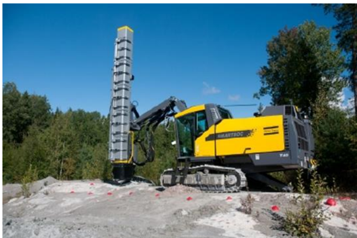
Slika 3-6. Zvučna izolacija vanjskog bušačkog čekića (Atlas Copco, 2010.)
