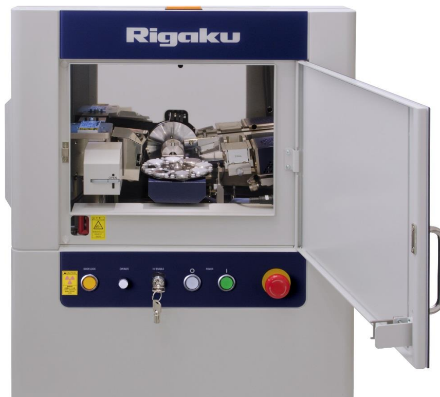
Slika 5-2 XRD MiniFlex je rendgenski difraktometar (ROFA d.o.o., 2019)
