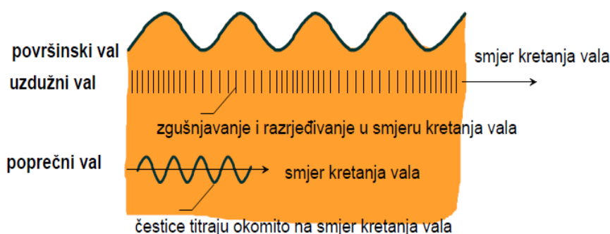
Slika 7-1 Vrste mehaničkih valova u tlu (Kvasnička i Domitrović, 2007)
