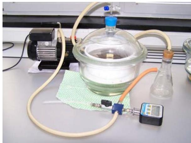
**Slika 2-2** Oprema za saturaciju (Briševac, 2012)
