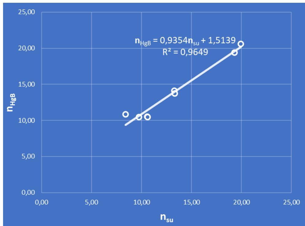
**Slika 3-7** Dijagram međuovisnosti poroznosti određene pomakom žive i Boylovim zakonom sa poroznosti određene saturacijom i uzgomom
