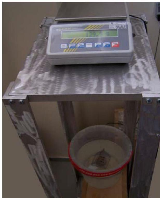
**Slika 2-3** Vaga za mjerjenje uronjene mase (Briševac, 2012)
