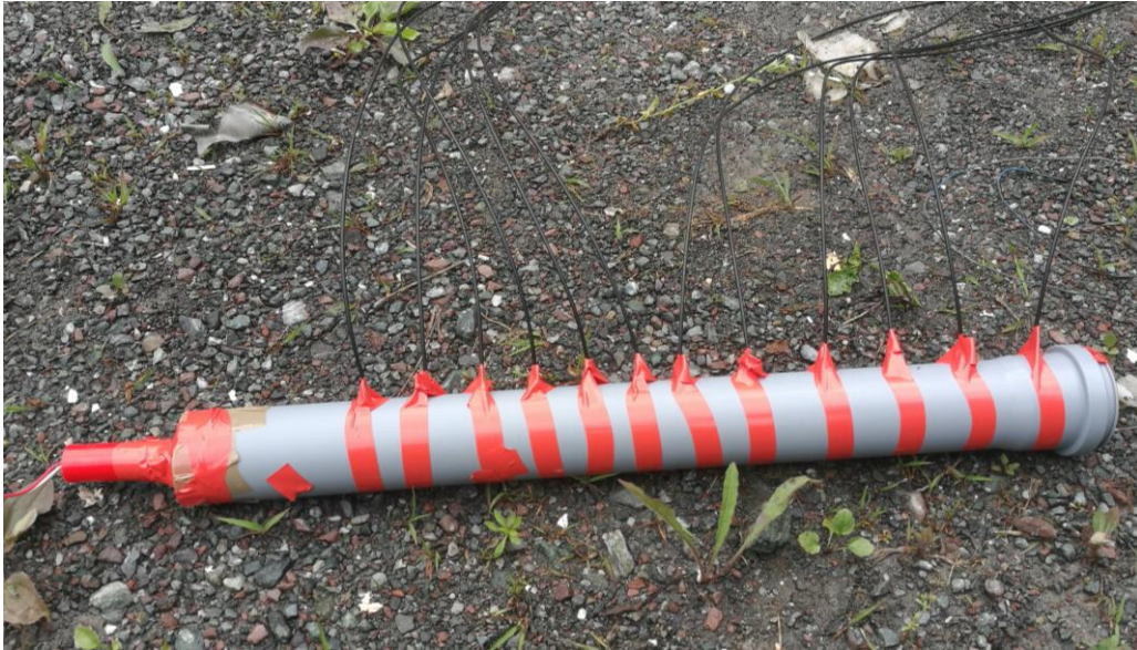
Slika 4-1. Mjerenje radijusa zakrivljenosti detonacijske fronte.
