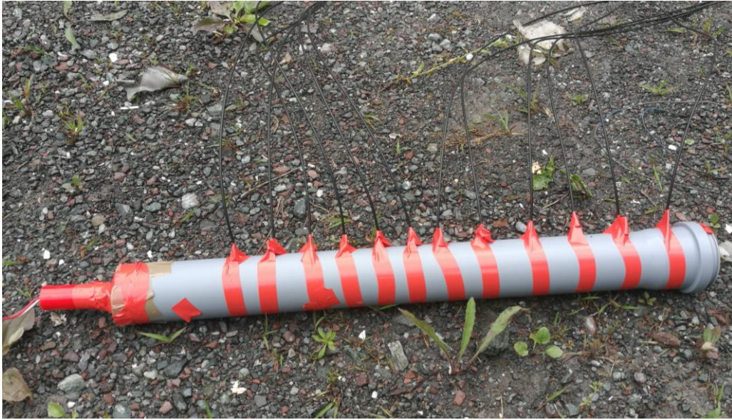
Slika 4-1. Mjerenje radijusa zakrivljenosti detonacijske fronte.
