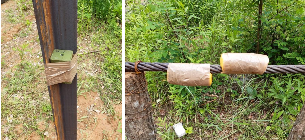
Slika 3-6. Jednostrano i dvostrano postavljanje eksplozivnog naboja.
