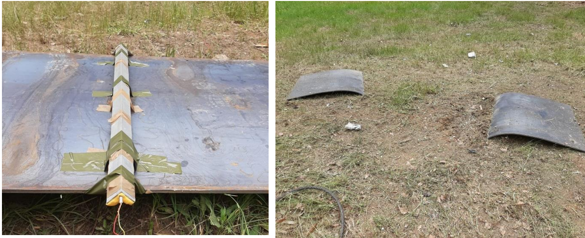
Slika 3-12. Rezanje metalne ploče primjenom linijskog kumulativnog rezača.
