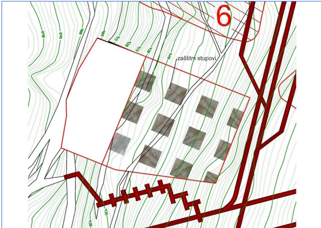
Slika 4-2 Raspored zaštitnih stupova na ležištu a-g kamena Crvene Stijene (Čavar, 2011).
