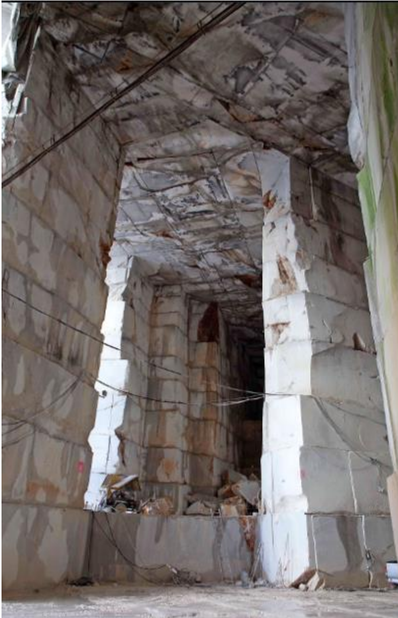
Slika 3-6 Visoke galerije s nepravilnim rasporedom stupova, Marmor Sežana, Slovenija
