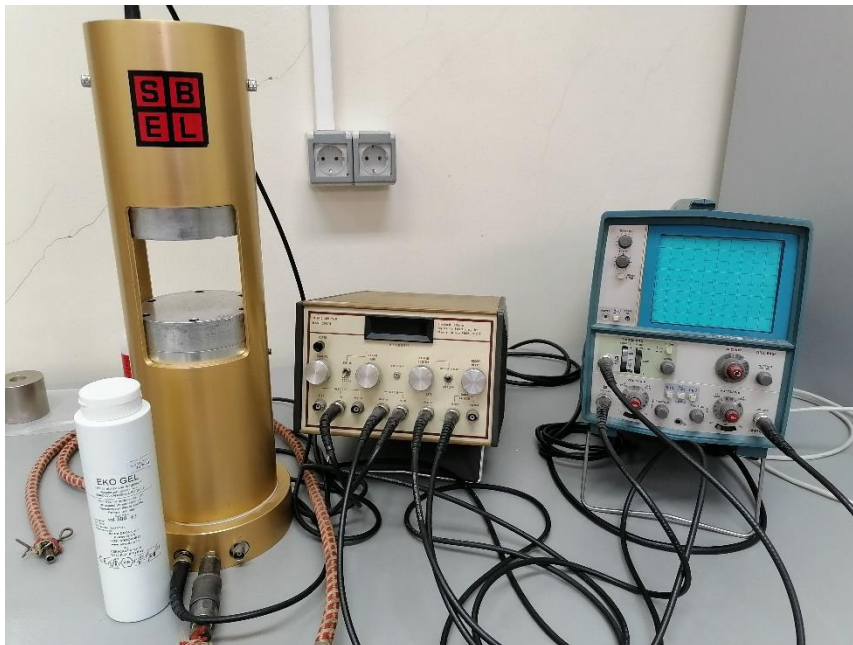
Slika 4-11 Uređaj za ispitivanje brzine prolaza ultrazvučnih elastičnih valova
