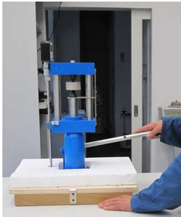
Slika 4-12 Uređaji za ispitivanje opterećenjem u točki (Briševac, 2012)
