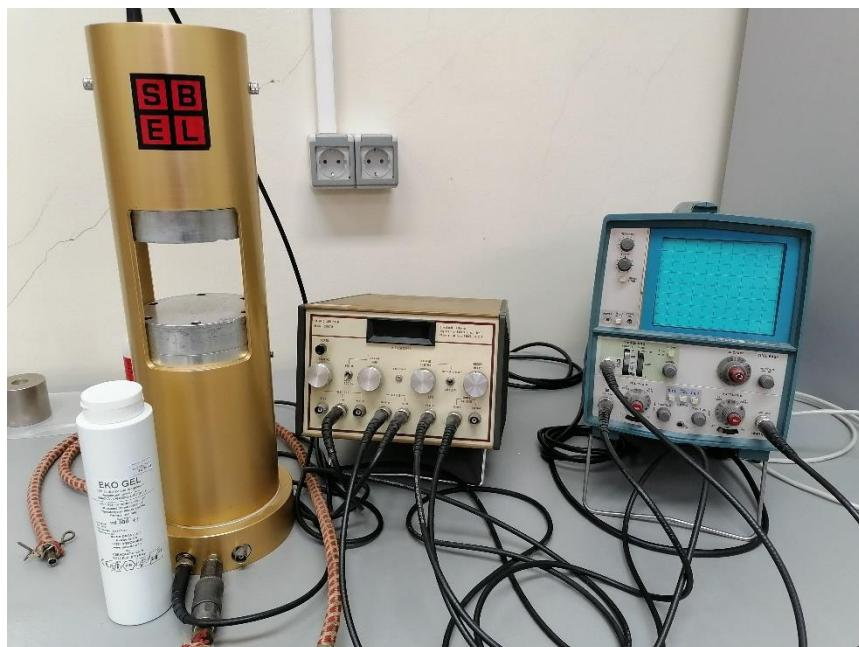
Slika 4-11 Uredaj za ispitivanje brzine prolaza ultrazvučnih elastičnih valova
