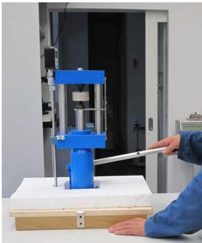
Slika 4-12 Uredaji za ispitivanje opterećenjem u točki (Briševac, 2012)
