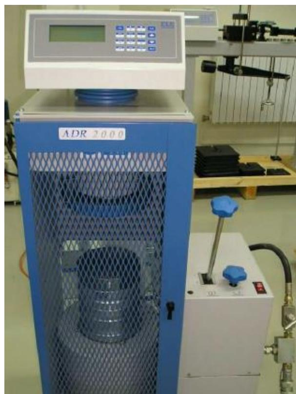
Slika 4-9 Hidraulična preša ELE ADR 2000 (Hrženjak i Briševac, 2009)
