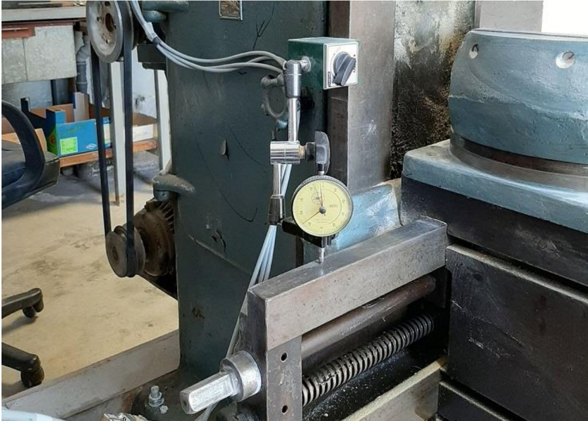
Slika 4-6 Uređaj za podešavanje dubine reza – mikroura
