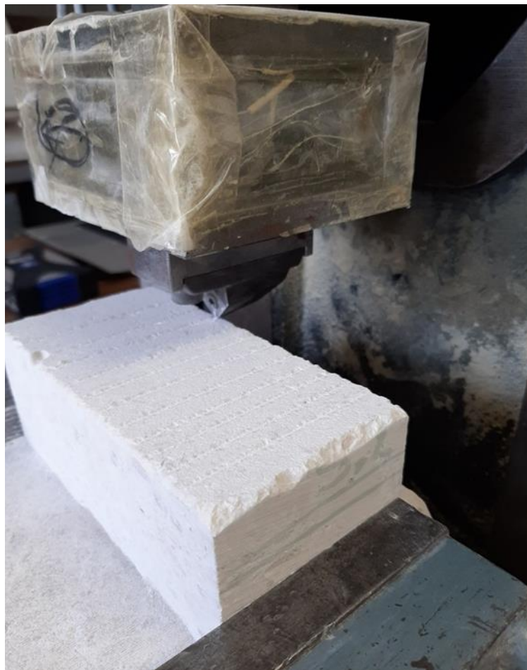
Slika 4-7 Prikaz pripremljenog uzorka neposredno prije samog rezanja na početnoj udaljenosti
