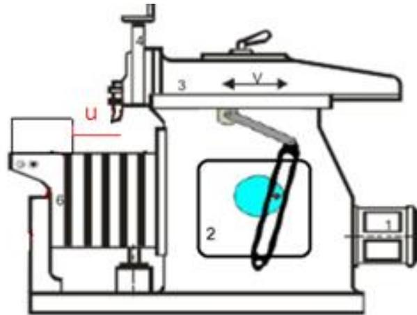
**Slika 4-9** Udaljenost  $u$  vrha rezne pločice do uzorka
