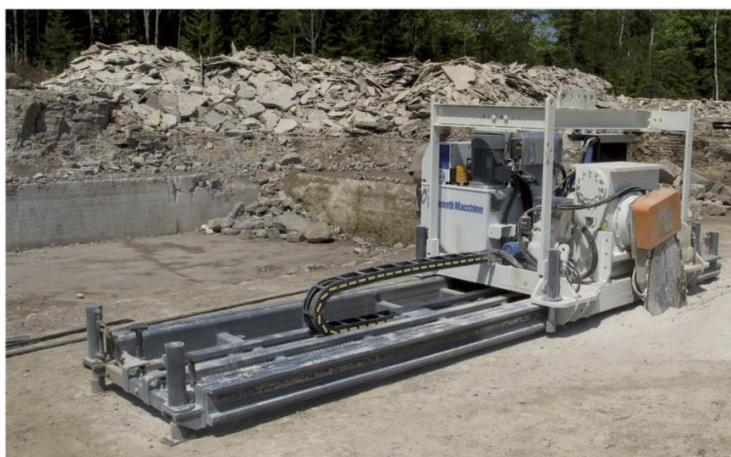
**Slika 2-1** Lančana sjekačica na tračnicama (Dunda i Kujundžić, 2003).
