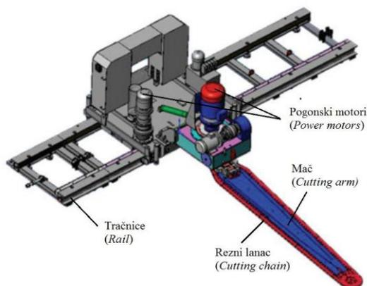
**Slika 2-2** Osnovni dijelovi lančane sjekačice (Sariisik et al, 2010).
