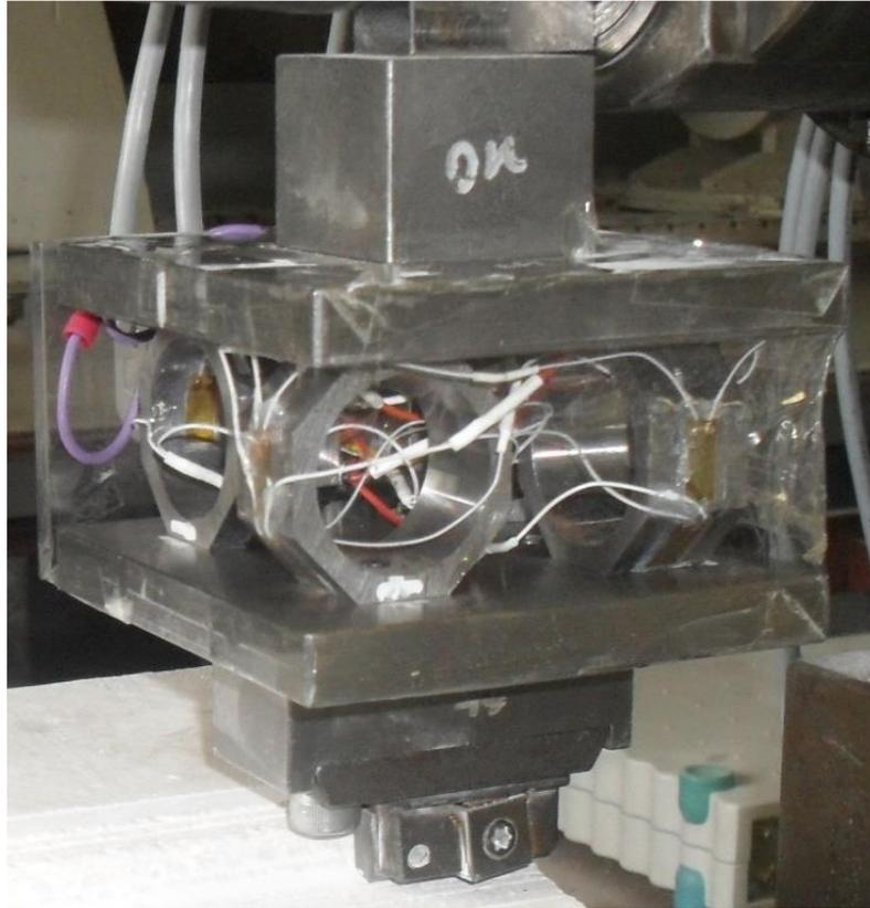
**Slika 4-4** Troosni mjerni pretvornik sile (Korman, 2014).
