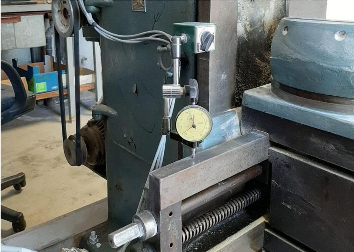
Slika 4-6 Uređaj za podešavanje dubine reza – mikroura
