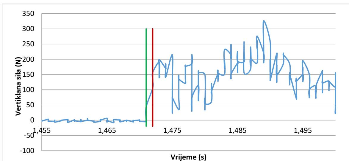
**Slika 4-8** Vertikalna sila na početku reza (zelena linija označava početak reza)
