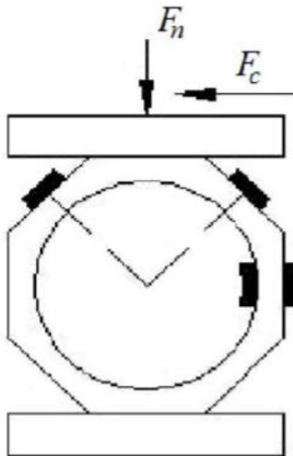
**Slika 4-3** Položaj traka za mjerenje deformacija (Saglam i Unuvar, 2001).
