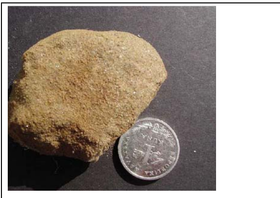
Slika 3.27: Uzorak sitnozrnatog litoarenita u vršnom dijelu ležišta TUV u bušotini Klo-57 (788,9 – 793,3 m, II. m) (autor TADEJ, J., iz studije: VELIĆ et al., 2008*)
