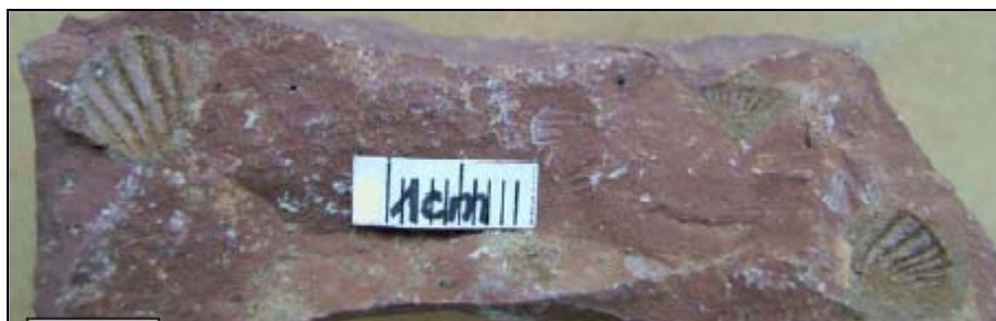
Slika 3.23: Uzorak proslojka pjeskovitog fosilifernog lapora u ležištu R iz bušotine Klo-1 (911,9 – 917,9 m, 1 m) s makrofosilima (autor TADEJ, J., iz studije: VELIĆ et al., 2008*)
