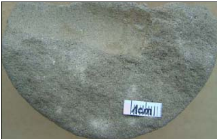
Slika 3.11: Uzorak litoarenita iz ležišta Beta u bušotini Klo-82 (1404,6 – 1411,7 m, II m) (autor TADEJ, J., iz studije: VELIĆ et al., 2008*)
