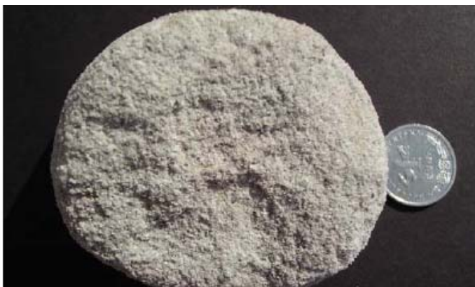
Slika 3.9: Uzorak arkoznog arenita iz ležišta Gama u bušotini Klo-88 (1378,0 – 1381,4 m, 1 m) (autor TADEJ, J., iz studije: VELIĆ et al., 2008*)
