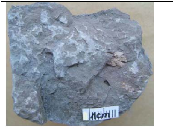
Slika 3.29: Uzorak proslojka lapora u ležištu Z u bušotini Klo-12 (1071,0 – 1073,0 m, I m) (autor TADEJ, J., iz studije: VELIĆ et al., 2008*)
