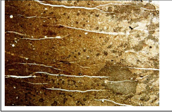
Slika 3.30: Lapor s otvorenom mikrofrakturnom poroznošću, (Klo – 12, 1071,0 – 1073,0 m, I. m) (autor TADEJ, J., iz studije: VELIĆ et al., 2008*)
