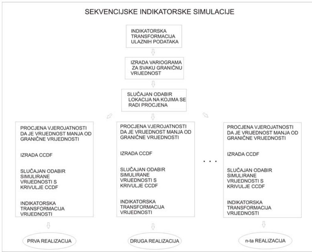
*Slika 5.3: Dijagram toka obrade podataka metodom sekvencijskih indikatorskih simulacija*
