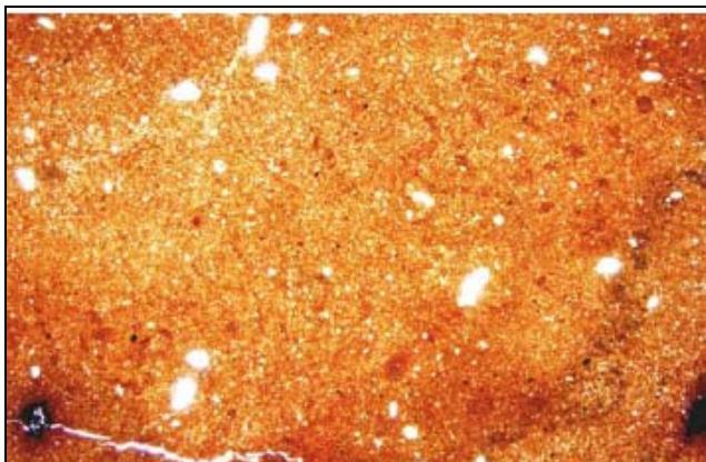
*Slika 3.24: Pjeskoviti fosiliferni lapor sa slabo razvijenom otvorenom mikrofraktturnom poroznošću, (Klo – I, 911,9 – 917,9 m, I m) (autor TADEJ, J., iz studije: VELIĆ et al., 2008\*)*
