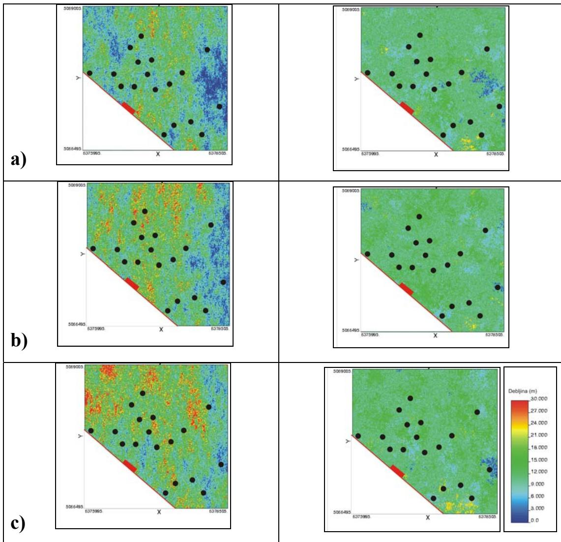
*Slika 9.31: Usporedba realizacija distribucije debeline ležišta  $T$  dobivenih sekvencijskim Gaussovim simulacijama (lijevo) i sekvencijskim indikatorskim simulacijama (desno): a) prva realizacija, b) pedeseta realizacija i c) stota realizacija*
