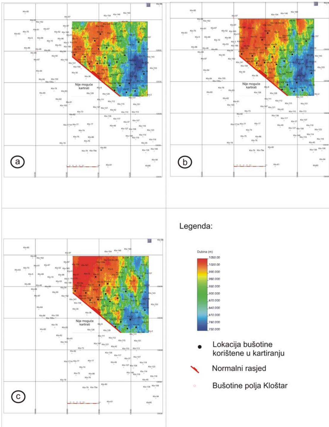
*Slika 9.6: Distribucija dubine ležišta T kartirana sekvenčnim Gaussovim simulacijama: a-prva realizacija, b-pedeseta realizacija i c-stota realizacija*
