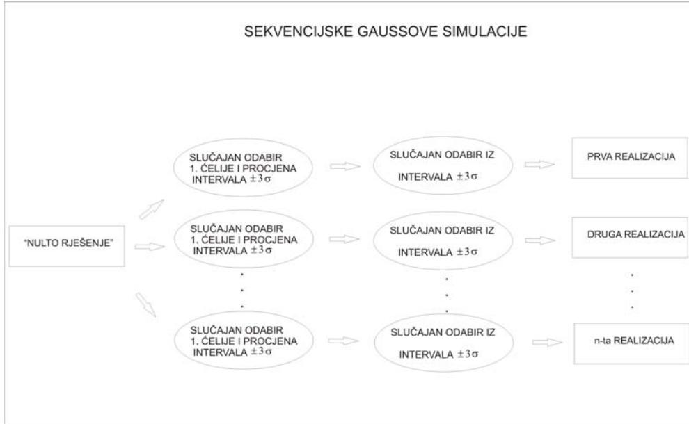
*Slika 5.2: Dijagram toka obrade podataka metodom sekvencijskih Gaussovih simulacija*
