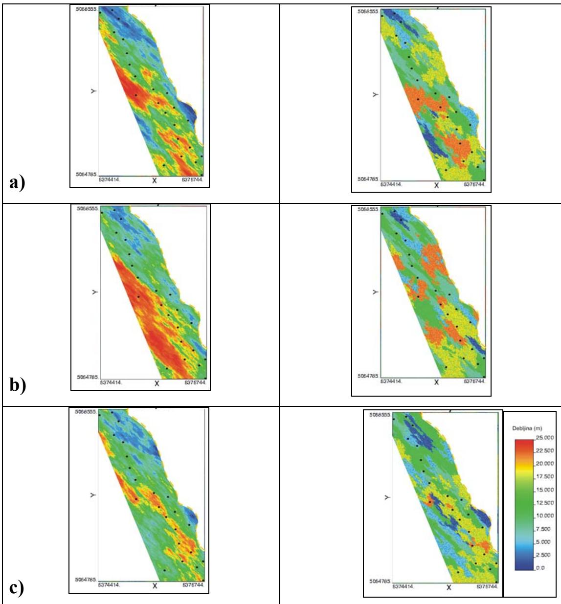
*Slika 9.29: Usporedba realizacija distribucije debeljine ležišta Beta dobivenih sekvenčnim Gaussovim simulacijama (lijevo) i sekvenčnim indikatorskim simulacijama (desno): a) prva realizacija, b) pedeseta realizacija i c) stota realizacija*
