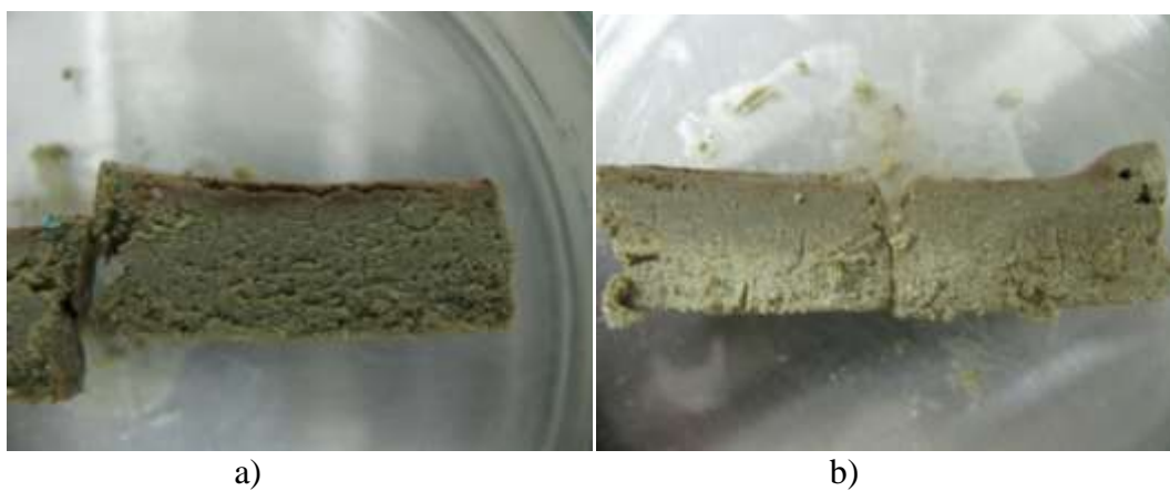
Slika 3-93. Izgled poprečnog presjeka peleta 20Q80M0K nakon bubrenja u kalijskoj isplaci K4PAC (a) te u gipsnoj isplaci G4PAC (b)
