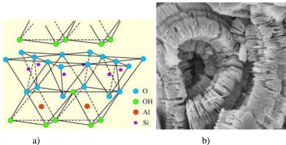
Slika 2-13. Struktura kaolinita (a) (<http://pubs.usgs.gov/>) i SEM fotografija kaolinita (b) (<http://originoflife.net/>)
