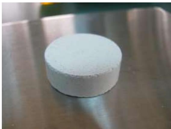
Slika 3-1. Izgled peleta nakon komprimiranja
