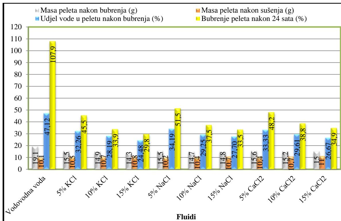
Slika 3-42. Utjecaj soli na ispitivane parametre peleta 10Q60M30K
