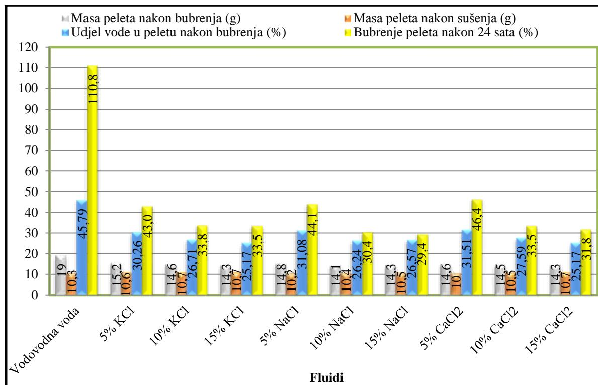
Slika 3-54. Utjecaj soli na ispitivane parametre peleta 20Q60M20K
