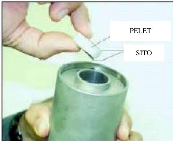
Slika 3-9. Umetanje peleta i sita u ispitnu ćeliju
