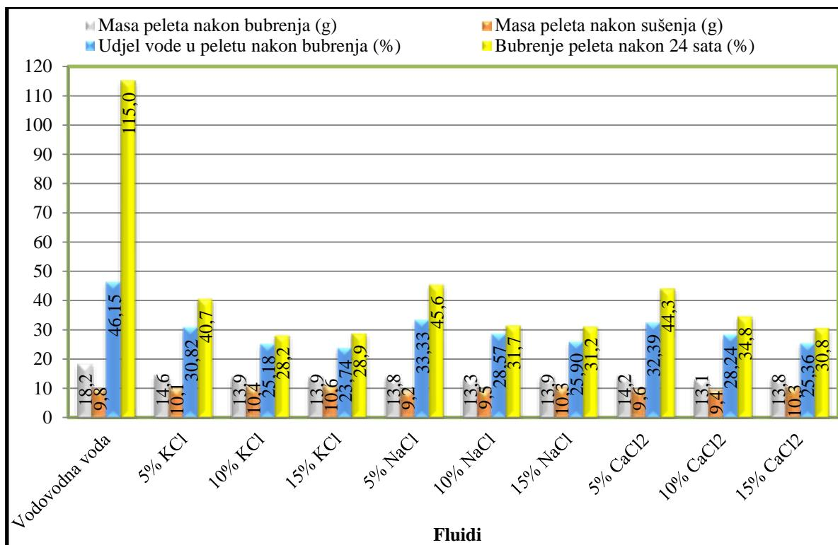
Slika 3-51. Utjecaj soli na ispitivane parametre peleta 20Q80M0K
