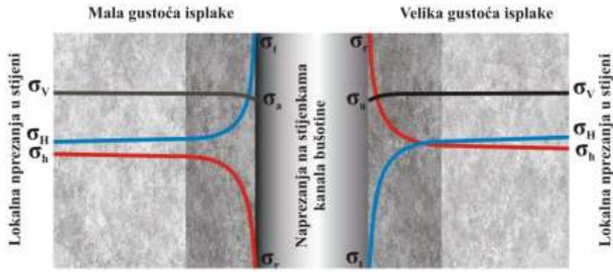
Slika 2-3. Utjecaj gustoće isplake na vrijednosti naprezanja na stijenkama kanala bušotine (\*\*\*, Rock Mechanics - Self Learning Course)
