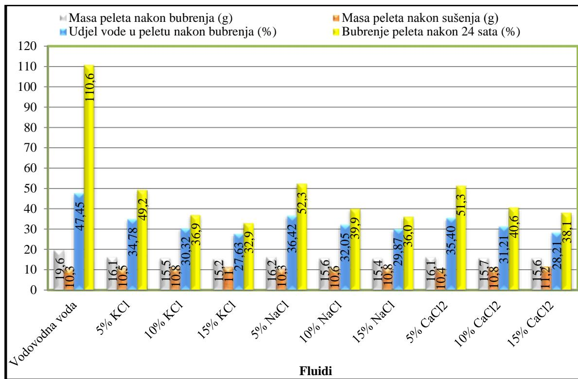
Slika 3-30. Utjecaj soli na ispitivane parametre peleta 0Q60M40K
