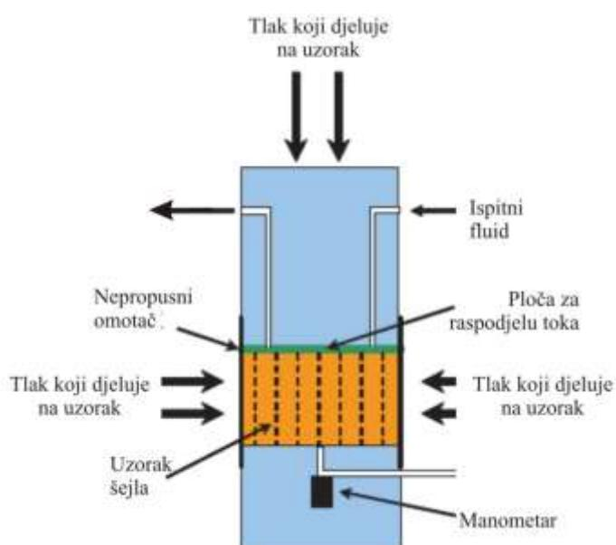
Slika 2-6. Shematski prikaz instrumenta za mjerjenje prijenosa tlaka i efikasnosti membrane (Ewy i Morton, 2009)
