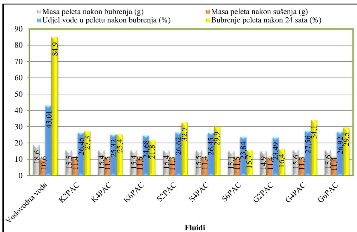
Slika 3-89. Utjecaj inhibiranih isplaka na ispitivane parametre peleta 10Q20M70K
