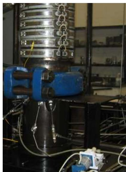
Slika 2-7. Čelija za simuliranje uvjeta u bušotini
