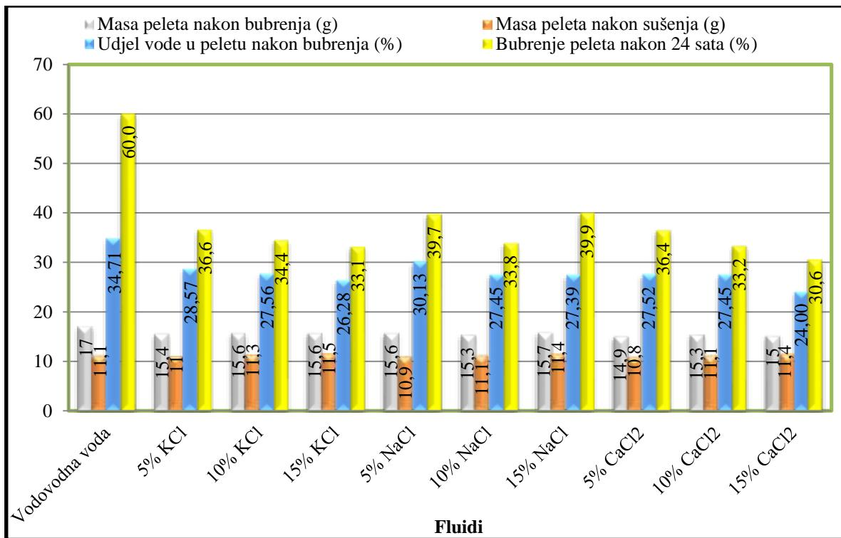
Slika 3-60. Utjecaj soli na ispitivane parametre peleta 20Q20M60K
