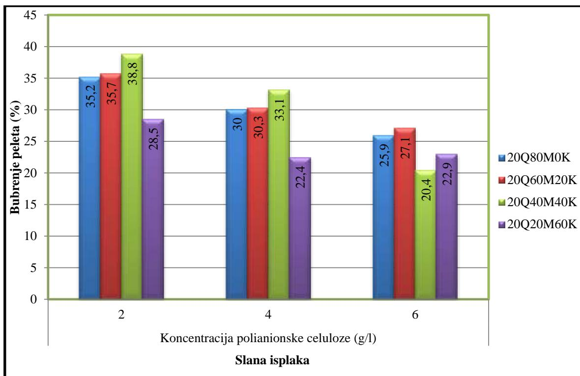
Slika 4-6. Utjecaj smanjenja udjela montmorilonita i povećanja udjela kaolinita u peletima s 20%-tnim udjelom kvarca na bubrenje u slanoj isplaci
