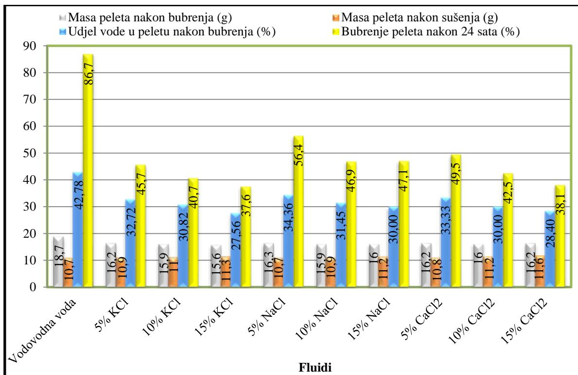
Slika 3-33. Utjecaj soli na ispitivane parametre peleta 0Q40M60K
