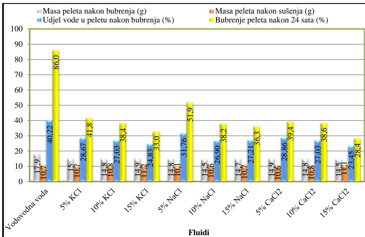
Slika 3-57. Utjecaj soli na ispitivane parametre peleta 20Q40M40K
