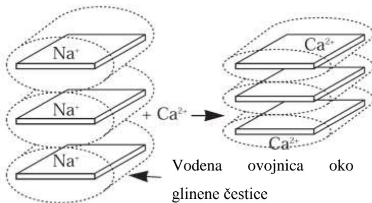
Slika 3-3. Djelomična dehidratacija glinene čestice uslijed zamjene  $\text{Na}^+$  kationa s  $\text{Ca}^{2+}$  kationima (MI SWACO „Drilling Fluids Manual“, 1998)
