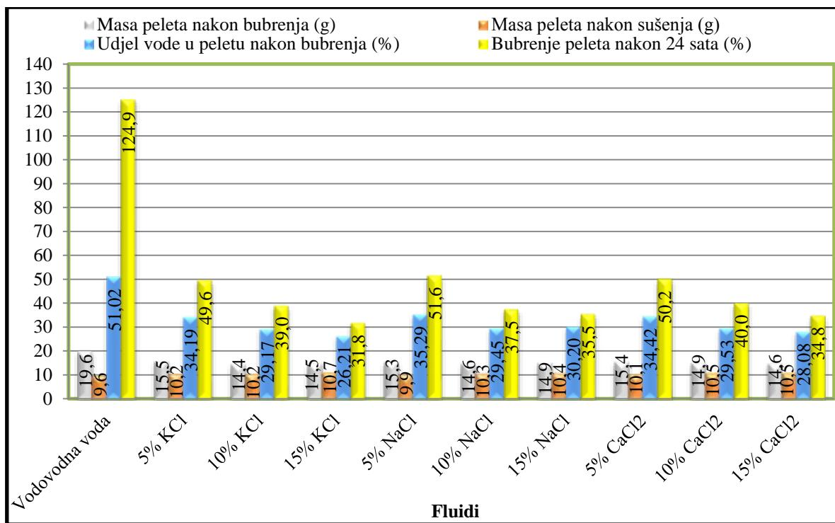
Slika 3-27. Utjecaj soli na ispitivane parametre peleta 0Q80M20K
