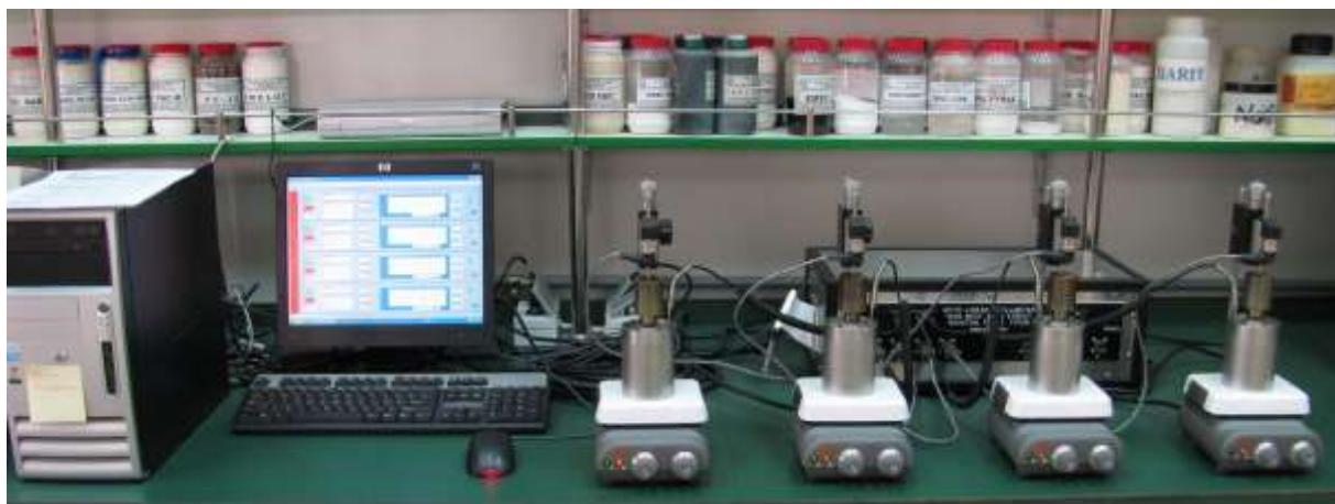
Slika 3-7. Uređaj za mjerjenje bubrenja peleta
