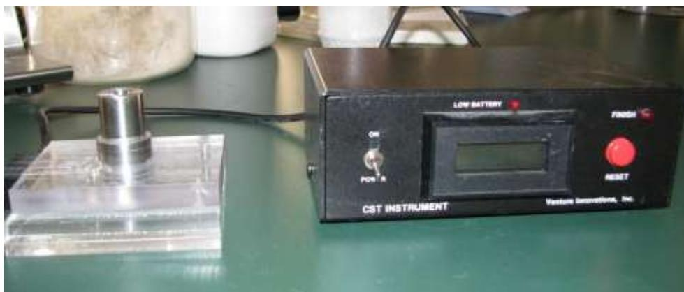
Slika 3-22. Uređaj za određivanje vremena kapilarnog upijanja isplake
