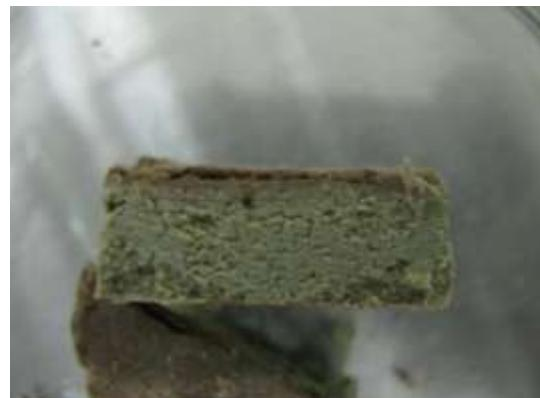
Slika 3-80. Izgled poprečnog presjeka peleta 10Q80M10K nakon bubrenja u kaliskoj isplaci K4PAC
