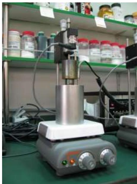
Slika 3-8. Jedinica za mjerjenje bubrenja peleta
