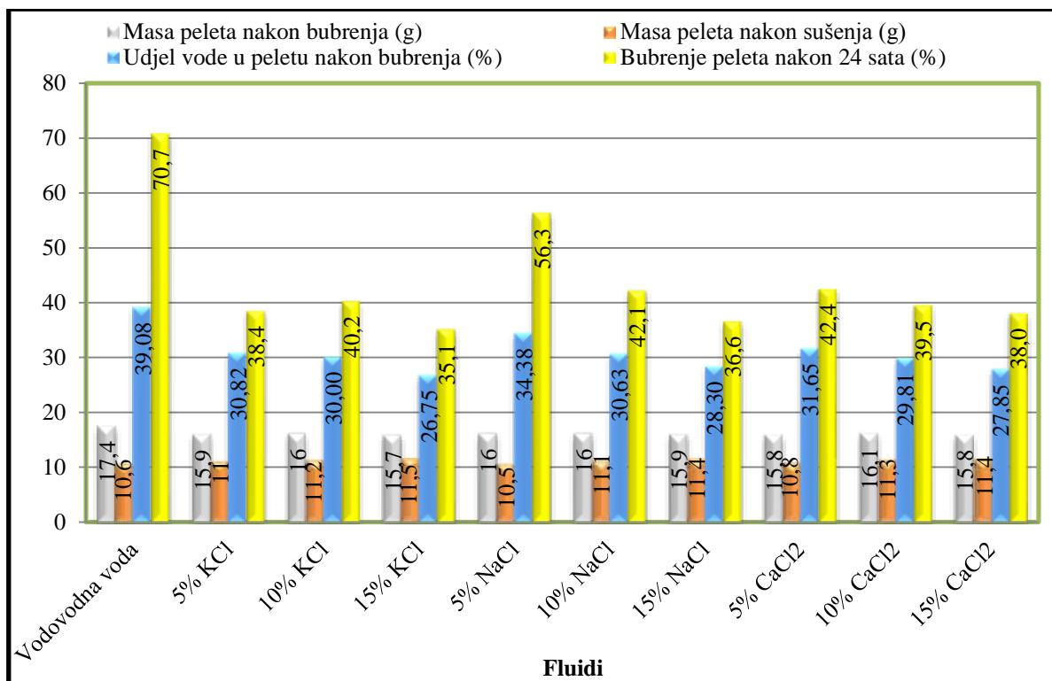
Slika 3-48. Utjecaj soli na ispitivane parametre peleta 10Q20M70K
