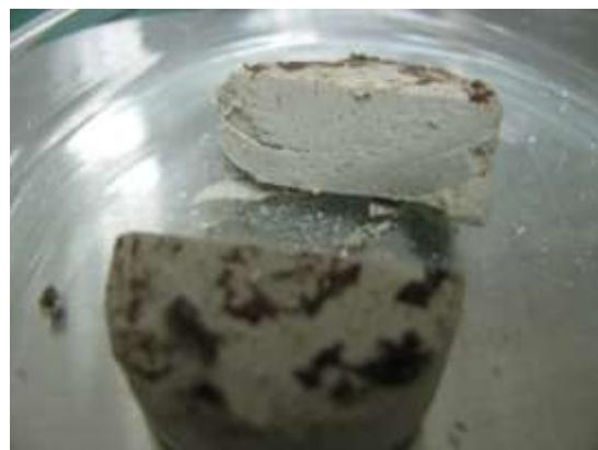
Slika 3-76. Izgled poprečnog presjeka peleta 0Q20M80K nakon bubrenja u gipsnoj isplaci G2PAC
