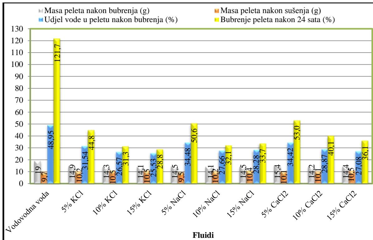
Slika 3-39. Utjecaj soli na ispitivane parametre peleta 10Q80M10K
