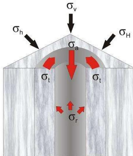
Slika 2-2. Preraspodjela naprezanja u stjeni tijekom bušenja
