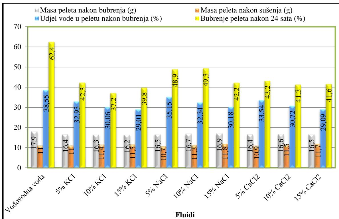
Slika 3-36. Utjecaj soli na ispitivane parametre peleta 0Q20M80K
