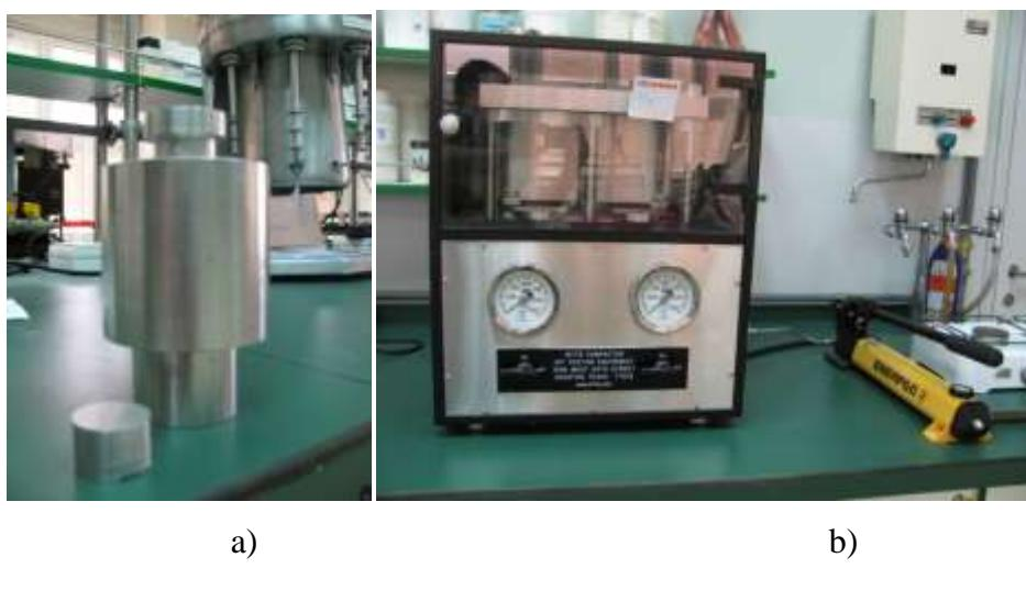
Slika 3-5. Čelija za izradu peleta (a) i uređaj za komprimiranje praškastog materijala s pumpom (b)
