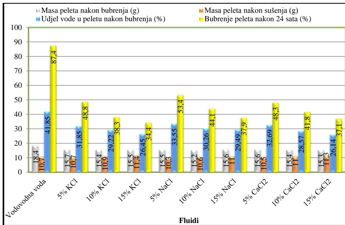
Slika 3-45. Utjecaj soli na ispitivane parametre peleta 10Q40M50K
