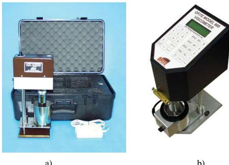
Slika 3-12. Fann viskozimetar (a) i OFITE viskozimetar model 900 (b)
