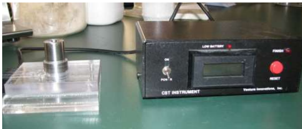
Slika 3-22. Uređaj za određivanje vremena kapilarnog upijanja isplake
