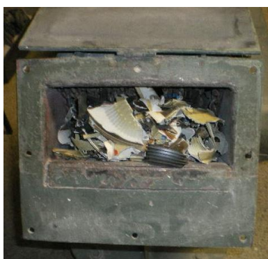
Slika 4 – 80 Sitnjenje u udarnoj drobilici IZ-0
