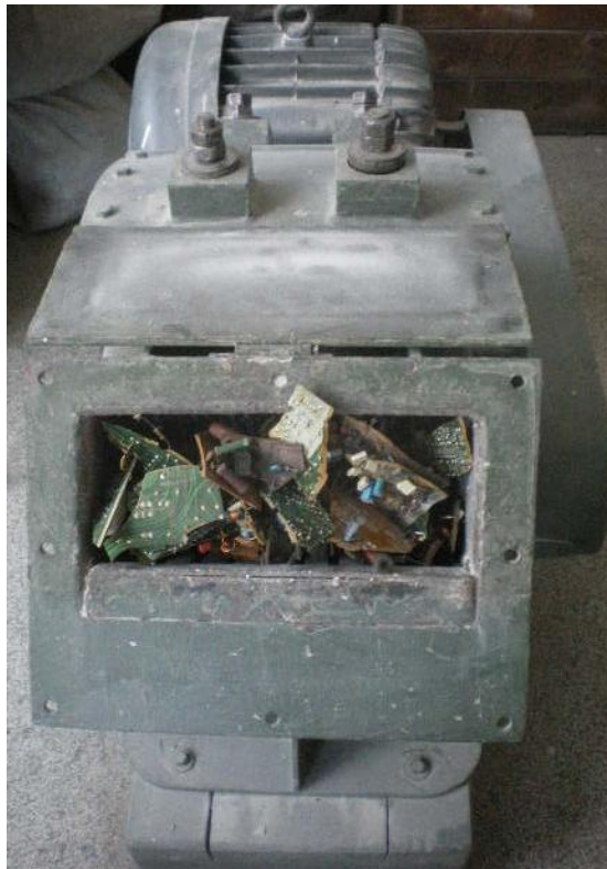
Slika 4 – 181 Sitnjenje u udarnoj drobilici IZ-0
