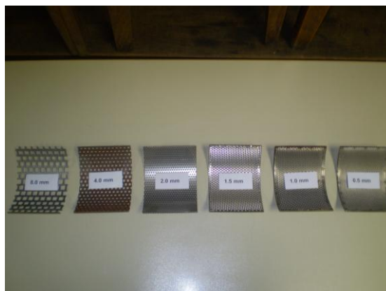
Slika 4 – 10 Rešetke za rezni mlin s veličinama otvora od 0,5 do 8,0 mm
