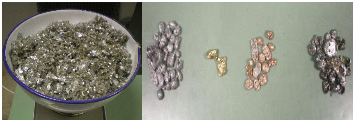
Slika 4 – 186 Aluminijaska folija i veći komadi aluminija, mesinga, bakra i željeza nakon sijanja na vibracijskom situ Denver Dillon
