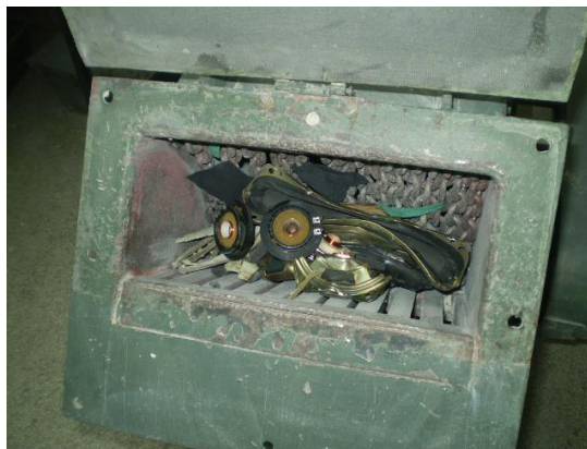
Slika 4 – 27 Sitnjenje zvučnika u udarnoj drobilici IZ-0
