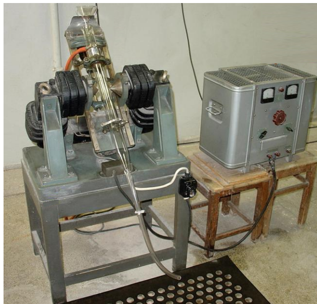
Slika 4 – 19 Laboratorijski mokri niskointenzivni magnetski separator 25T-CM ("завод имени Котлякова")
