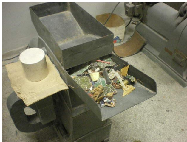
Slika 4 - 184 Sekundarno sitnjenje tiskanih pločica u udarnoj drobilici sa rotirajućim pločicama
