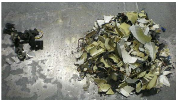
Slika 4 – 81 Razdvajanje materijala nakon sitnjenja u udarnoj drobilici IZ-0
