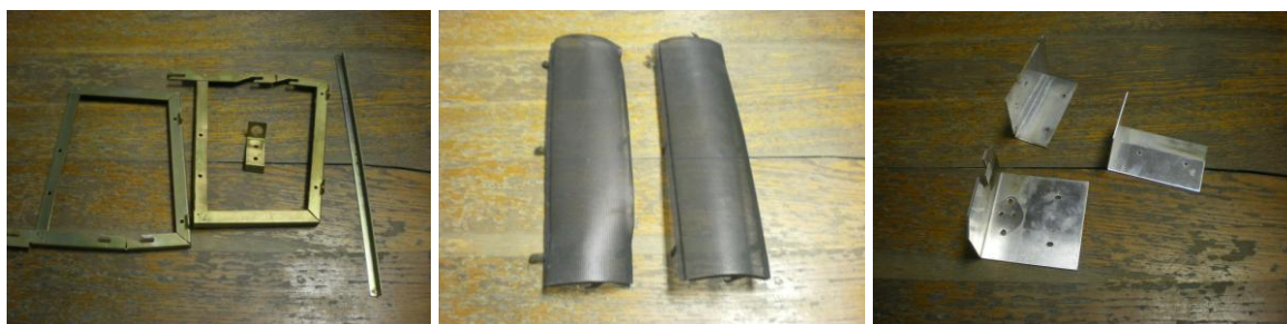
Slika 4 – 242 a) Željezni držači, b) mrežice zvučnika od aluminija i c) aluminijski limovi
