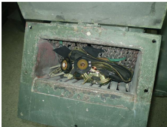
Slika 4 – 27 Sitnjenje zvučnika u udarnoj drobilici IZ-0
