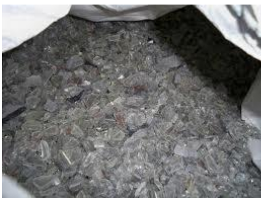
Slika 4 – 238 Usitnjeno olovno panel staklo sa katodne cijevi
