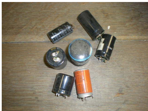
Slika 4 – 241 Elektrolitski kondenzatori \varnothing + 25 mm i visine + 25 mm
