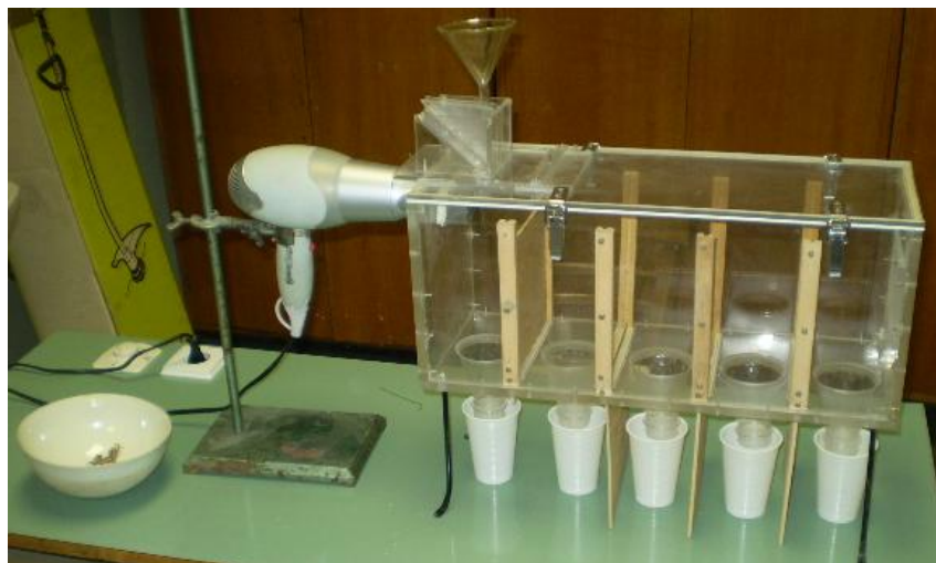
Slika 4 – 15 Model horizontalnog zračnog separatora (Bedečković i Salopek, 2008)
