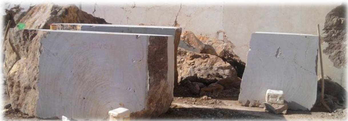
c) Dobiveni blokovi iz trapeznog usjeka
