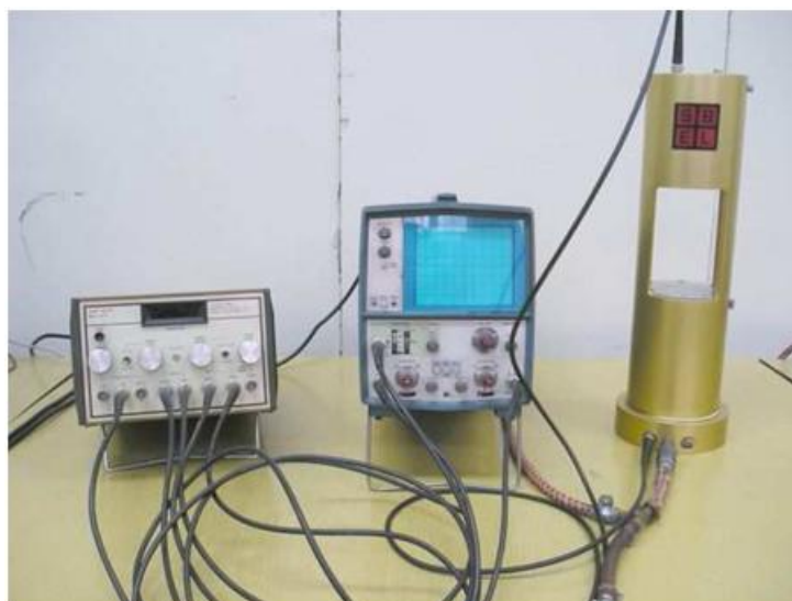
Slika 6.10. Seismic Analyser, model 2007H i sustav uređaja za mjerenje brzina prolaza ultrazvučnih elastičnih valova
