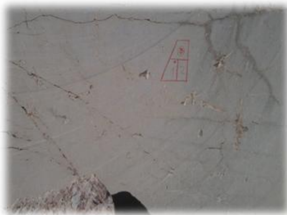
a) Plan izrade trapeznog usjeka
