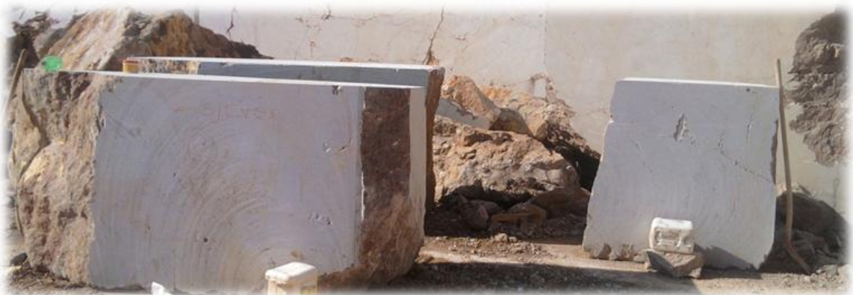
c) Dobiveni blokovi iz trapeznog usjeka
