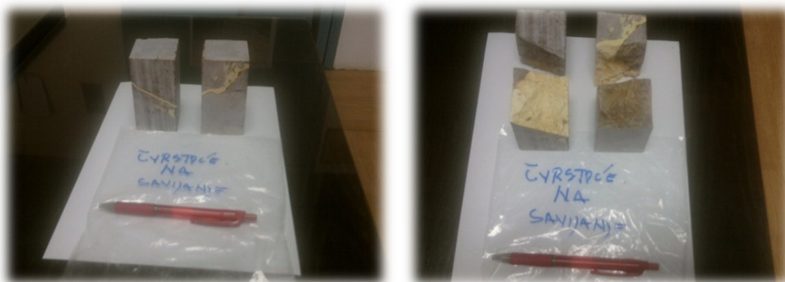
Slika 7.43. Zaliječeni uzorci prije i nakon ispitivanja čvrstoće na savijanje
