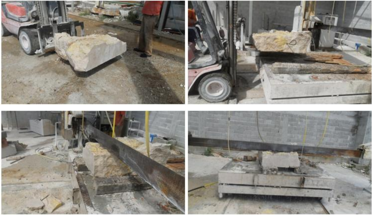
Slika 8.8. Raspilavanje na jednolisnoj pili
