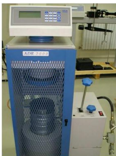
Slika 6.14. Hidraulična preša ELE ADR 2000
