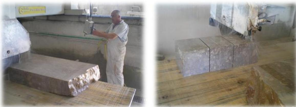
Slika 6.6. Tehnološka proba rezanja na disk pili
