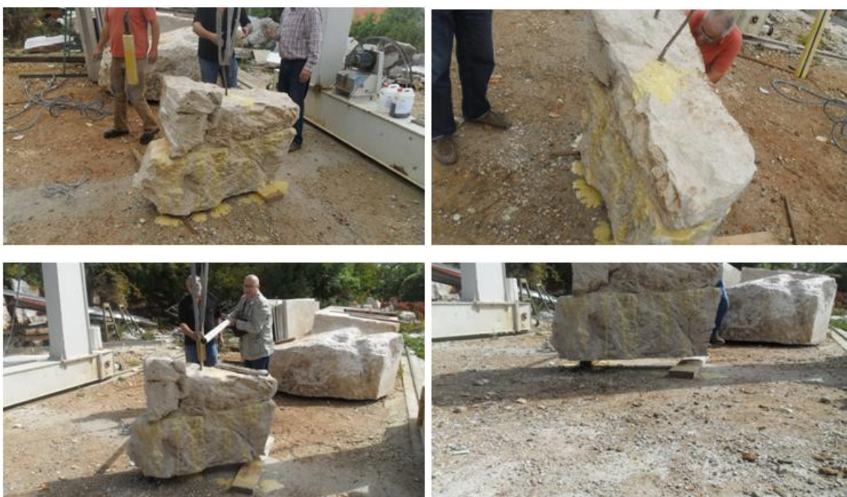
Slika 8.7. In situ ispitivanje vlačne čvrstoće zalijepljenog spoja
