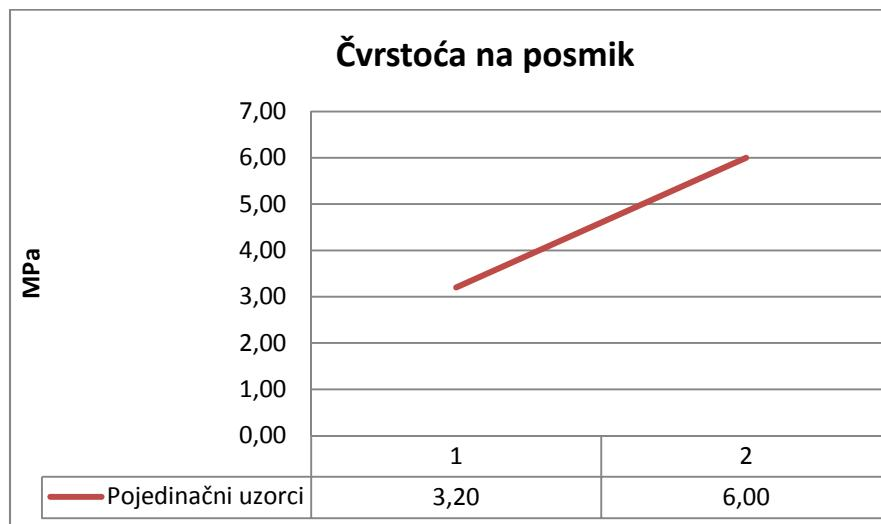
**Slika 7.46. Prikaz ispitivanja čvrstoće na posmik zalijepljene stijene**
