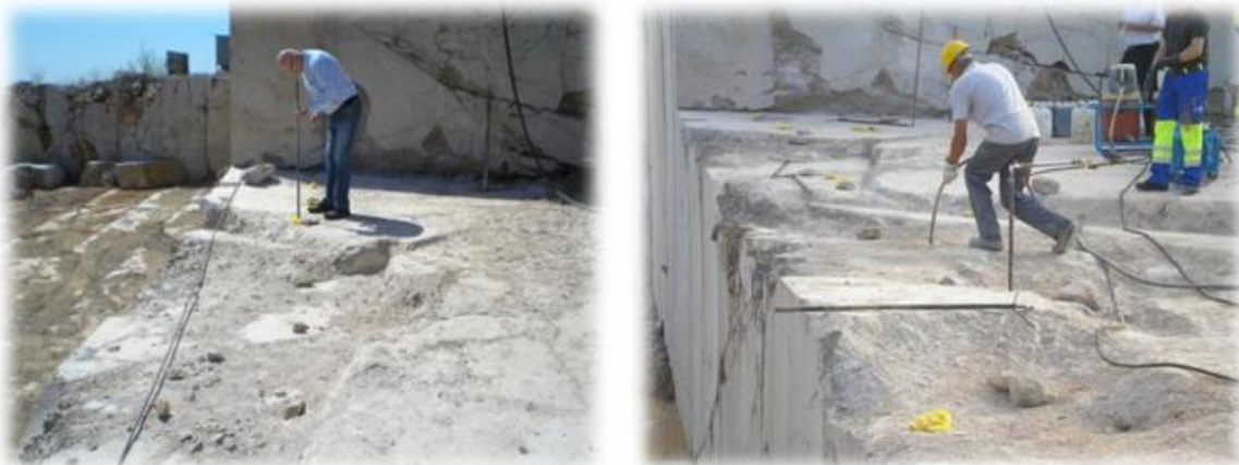
Slika 7.19. Provjera stanja, prohodnosti i dubine utisnih bušotina
