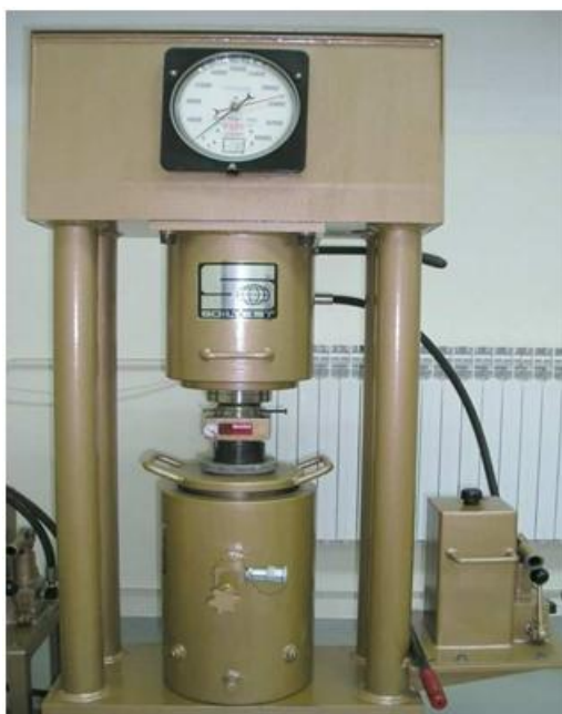
Slika 6.9. Preša SOILTEST CT-732
