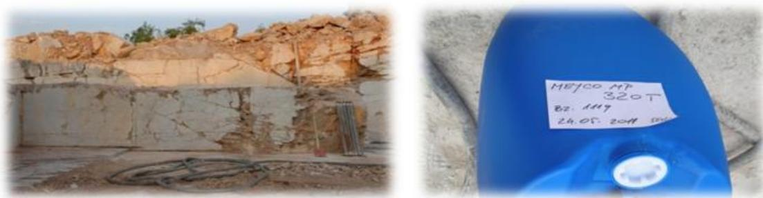
**Slika 7.29. Foto prikaz istočnog probnog polja i bačve s koloidnom silikom meyko MP 320**
