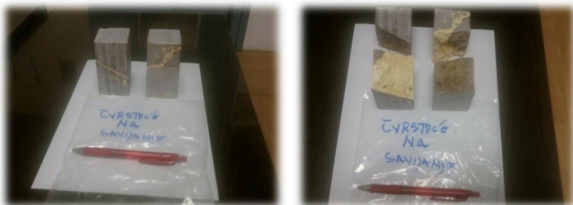
**Slika 7.43.** Zalijepljeni uzorci prije i nakon ispitivanja čvrstoće na savijanje
