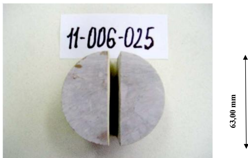
Slika 6.13. Uzorak zalijepljenog kamena oznake 11-006-025 nakon ispitivanja vlačne čvrstoće
