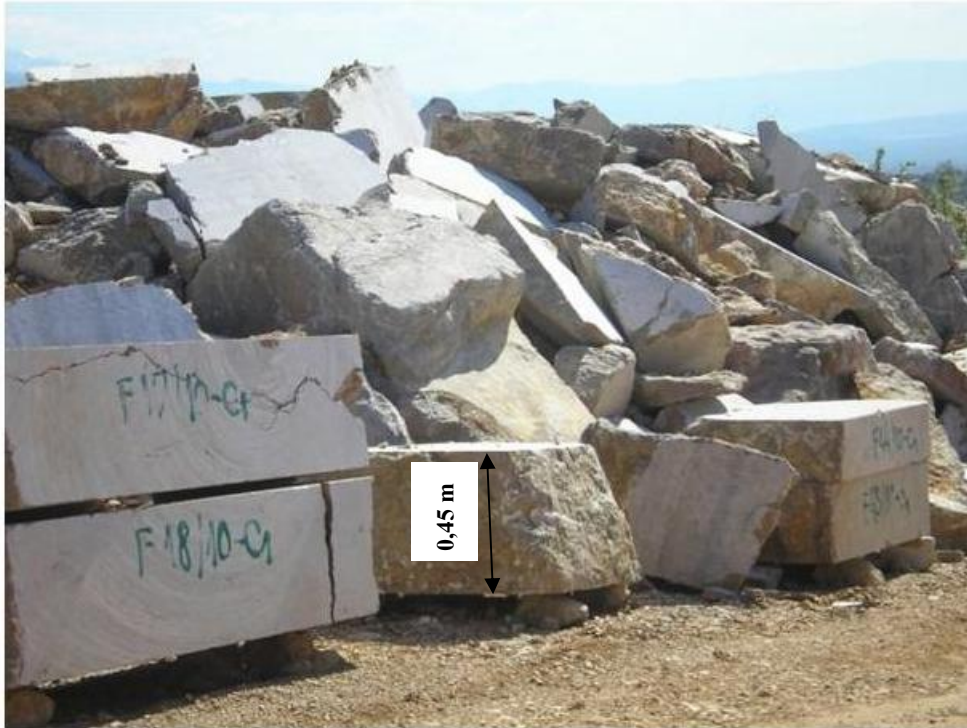
Slika 5.1. Nekomercijalni komadi arhitektonsko-građevnog kamena na površinskom kopu “Tvrda ljut”
