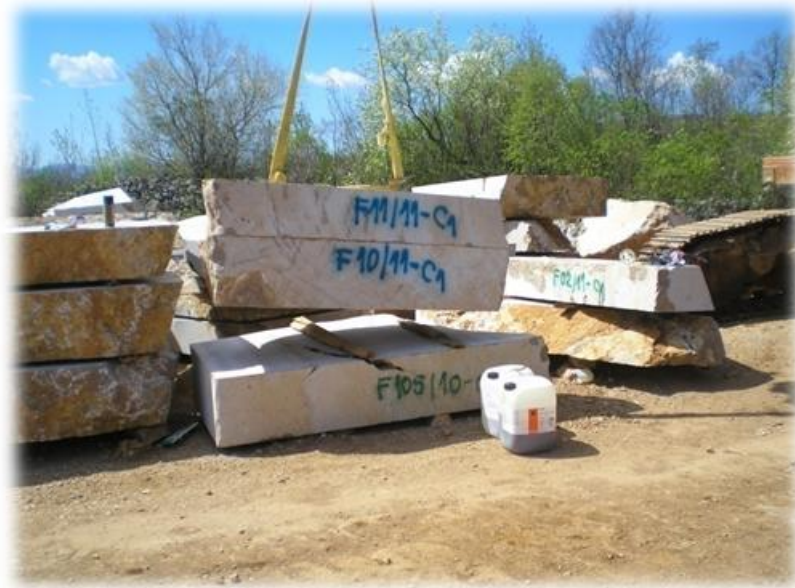
Slika 6.3. In situ ispitivanje čvrstoće zalijepljenog spoja
