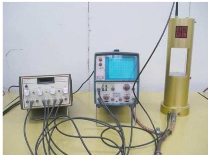
**Slika 6.10. Seizmic Analyser, model 2007H i sustav uređaja za mjerenje brzina prolaza ultrazvučnih elastičnih valova**
