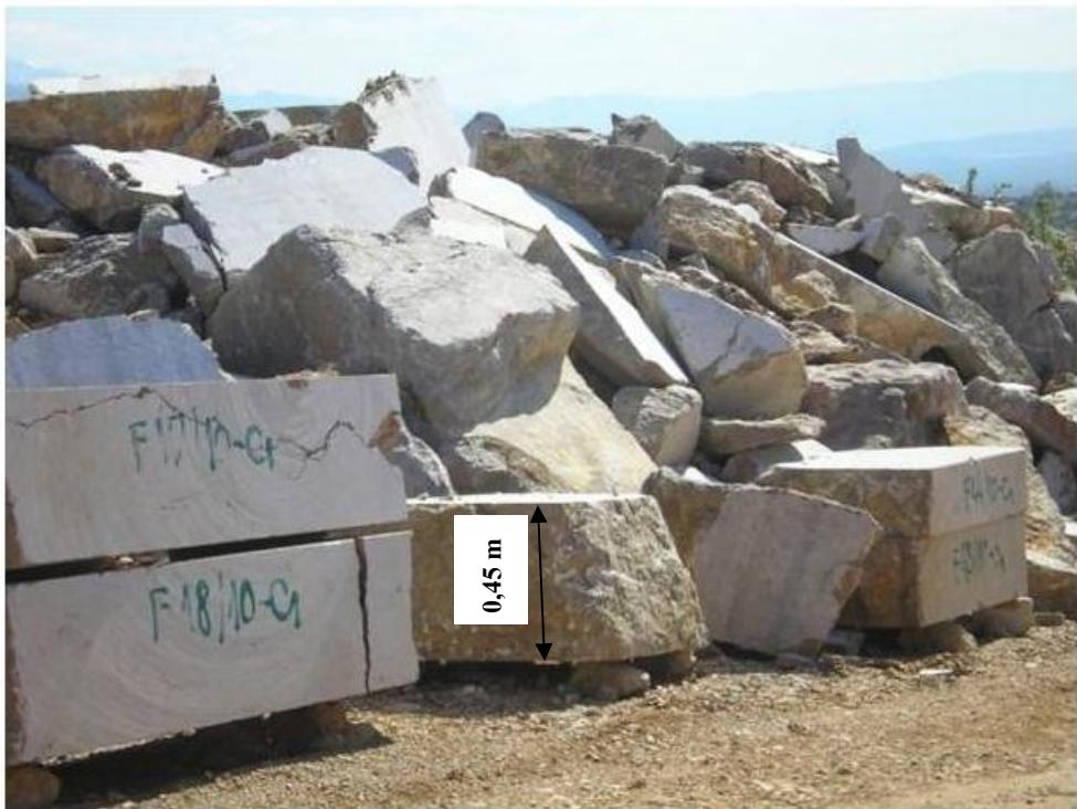
**Slika 5.1. Nekomercijalni komadi arhitektonsko-građevnog kamen na površinskom kopu "Tvrda ljud"**
