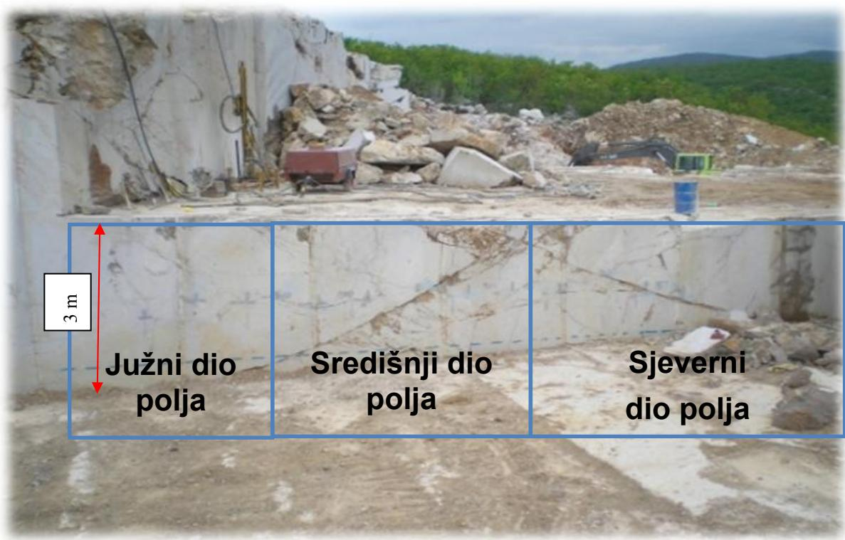
**Slika 7.31.** Prikaz plana podjele i rezanja blokova na zapadnom probnom polju,
