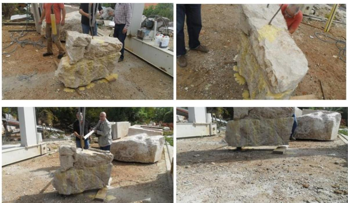
**Slika 8.7. In situ ispitivanje vlačne čvrstoće zaliđepljenog spoja**
