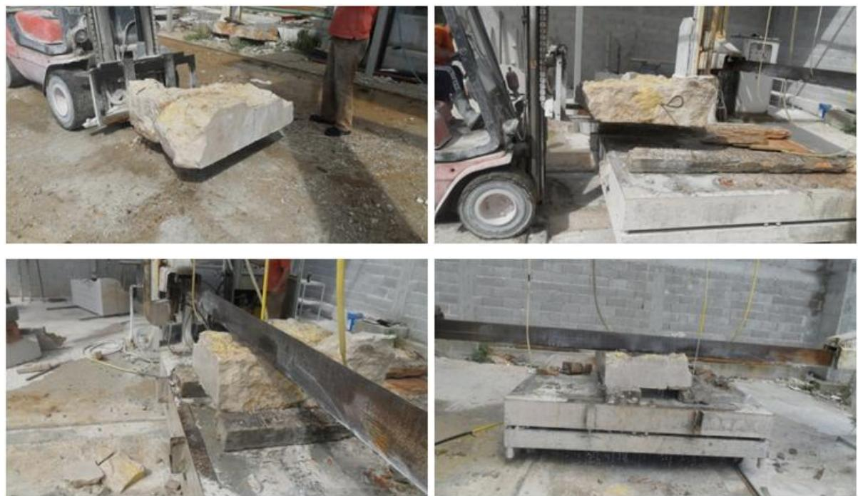
**Slika 8.8. Raspilavanje na jednolisnoj pili**
