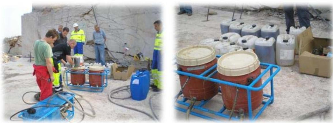
**Slika 7.21. Oprema i materijal potrebnii za izvođenje probe utiskivanja**
