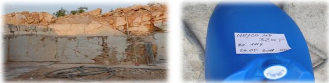
Slika 7.29. Foto prikaz istočnog probnog polja i bačve s koloidnom silikom meyko MP 320
