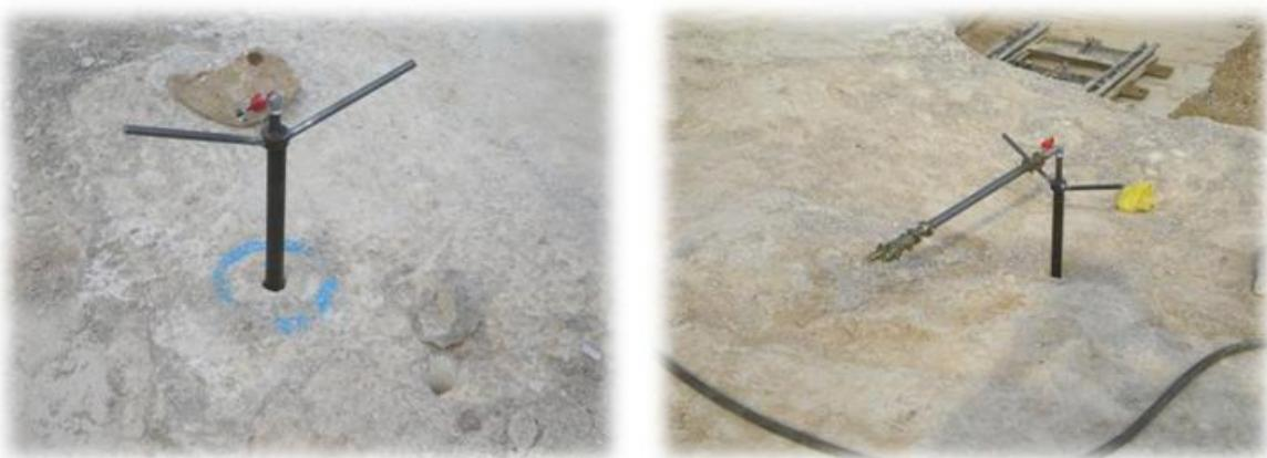
**Slika 7.22. Paker usidren u utisnu bušotinu bez i sa spojnom cijevi**
