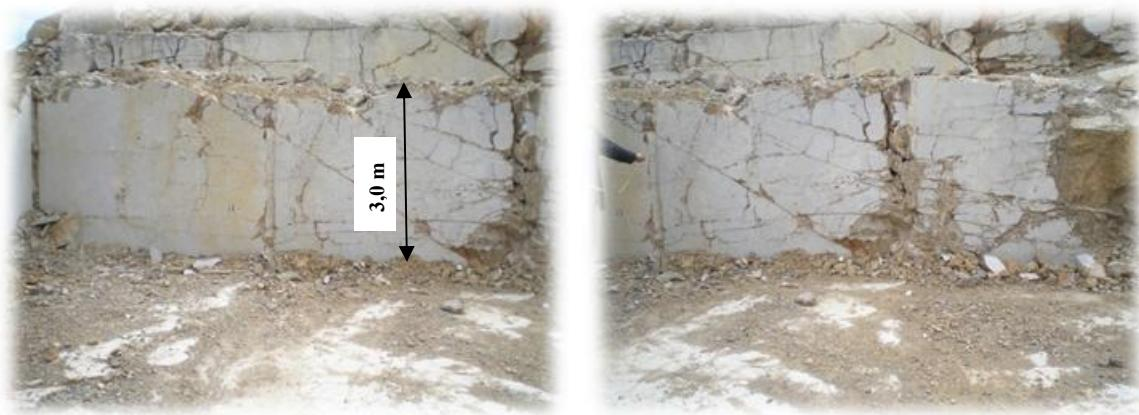
**Slika 7.9. Rasjed i pukotine evidentirane na istočnom čelu**
