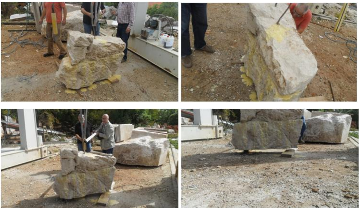
Slika 8.7. In situ ispitivanje vlačne čvrstoće zalijepljenog spoja
