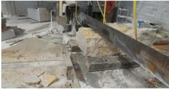
Slika 8.10. Shematski prikaz raspilavanja zalijepljenog bloka na jednolisnoj pili
