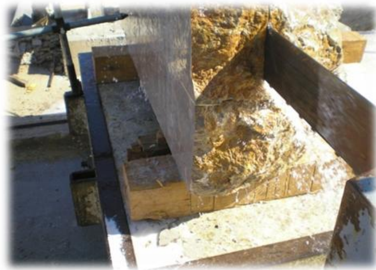
Slika 6.4. Tehnološka proba rezanja na jednolisnoj pili
