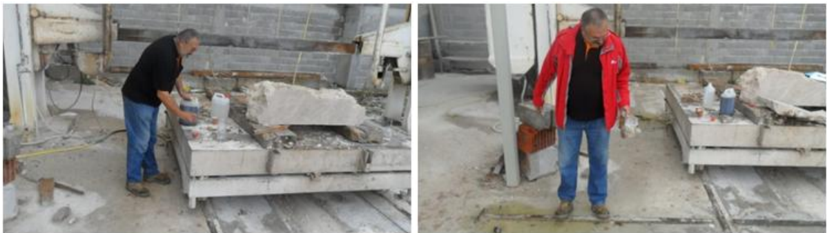
Slika 8.3. Ispitivanje reakcije brzine vezanja dvokomponentne urea silikatne smole
