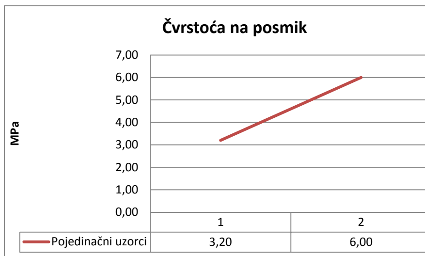
Slika 7.46. Prikaz ispitivanja čvrstoće na posmik zalijepljene stijene
