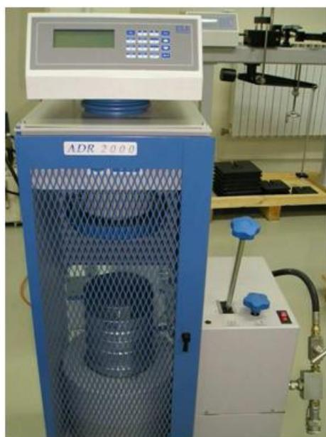
**Slika 6.14. Hidraulična preša ELE ADR 2000**
