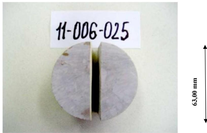
**Slika 6.13. Uzorak zalipljenog kamena oznake 11-006-025 nakon ispitivanja vlačne čvrstoće**
