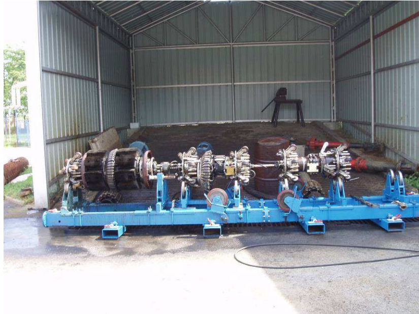
Slika 5-5. MagneScan DN 500 alat, GE Oil & Gas, PII, Njemačka
