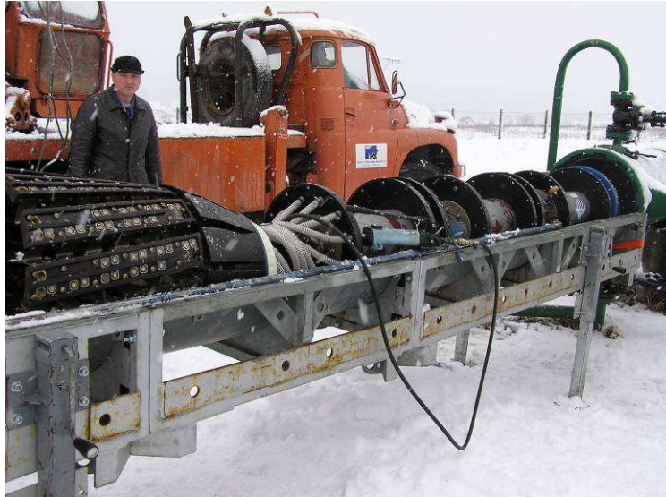
Slika 5-4. Ultrazvučni alat UltraScan DN 500 , GE Oil & Gas, PII, Germany
