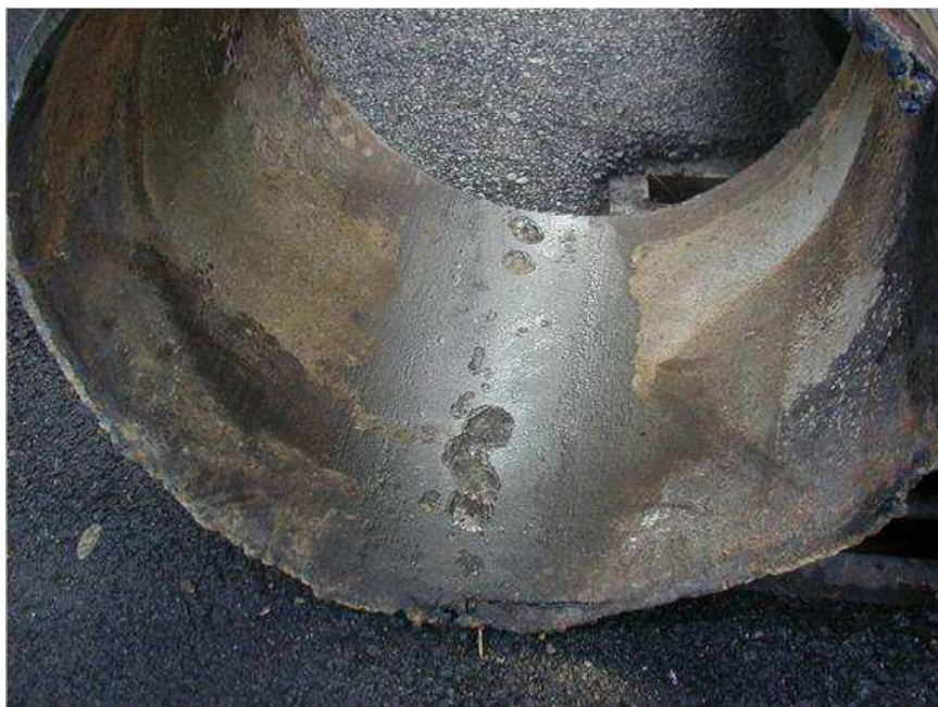
Slika 4-8. Izgled ispitnog uzorka naftovoda OS Stružec – RN Sisak
