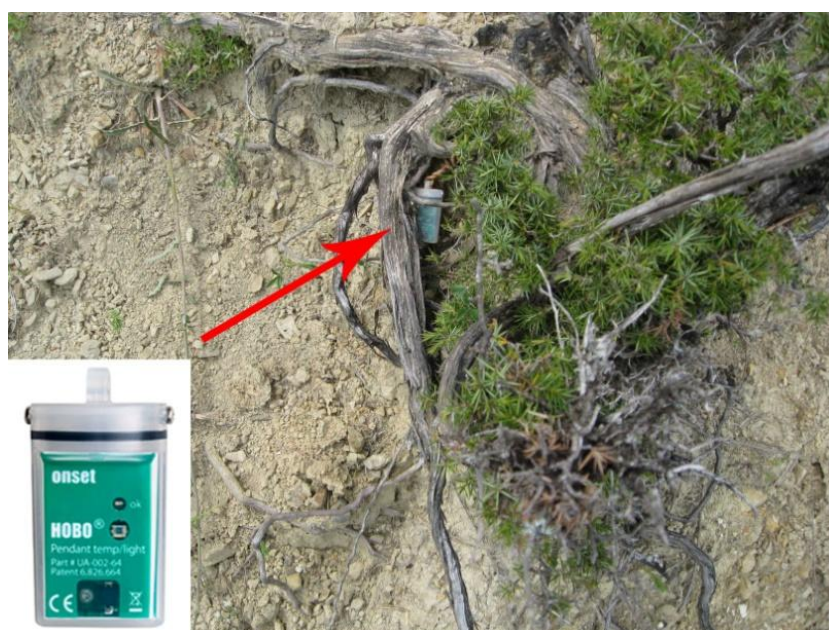
Slika 46 – Uređaj za mjerenje temperature zraka postavljen na terenu
