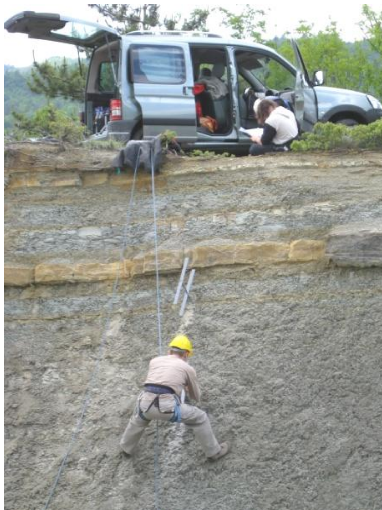
Slika 51 - Postavljanje i mjerenje nultog profila pomoću profilometara na ogolini Boljun
