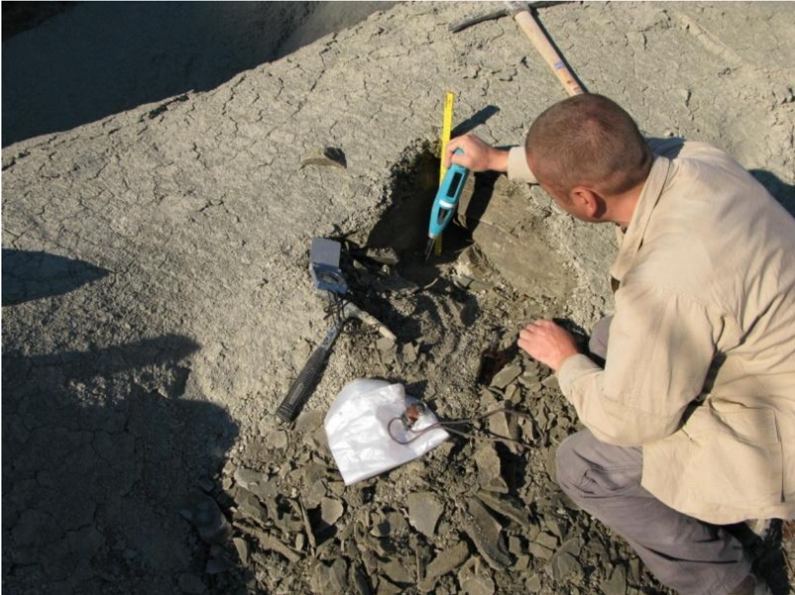
Slika 43 – Testiranje Schmidtovim čekićem na terenu
