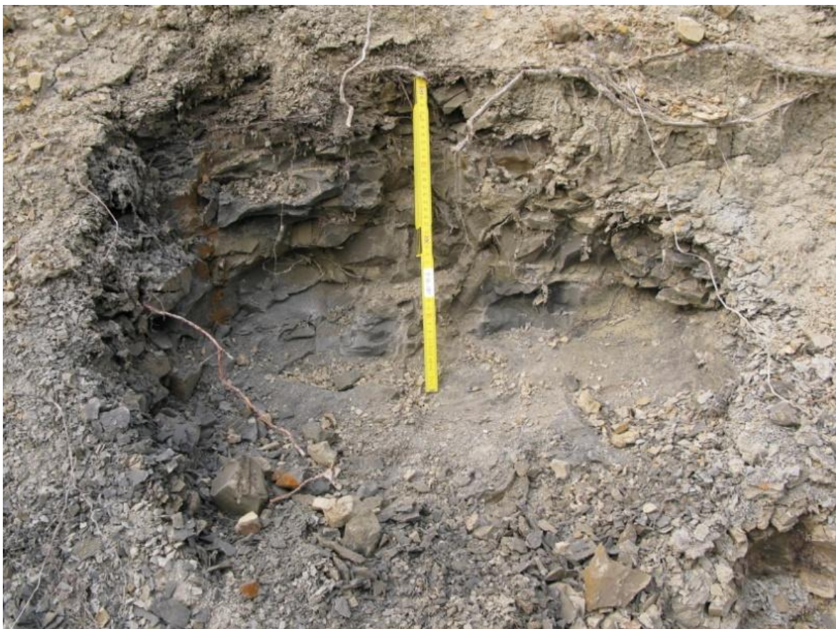
Slika 2 – Fizičko trošenje uzrokovano, između ostalog, rastom korijenja
