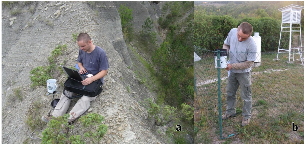
Slika 48 – Postavljanje kišomjera – a) na klin; b) na stup od ograde
