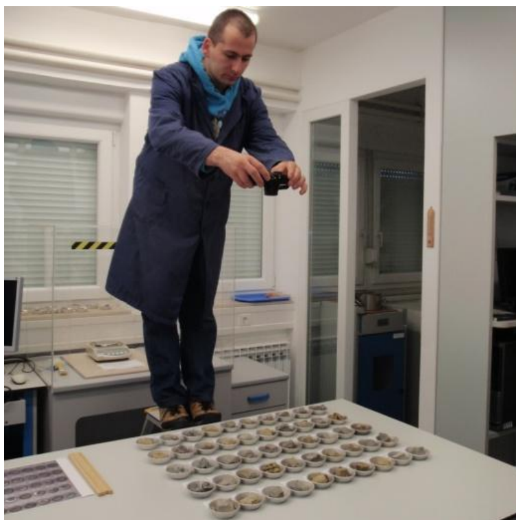
Slika 41 – Fotografiranje uzoraka podvrgnutih testu određivanja postojanosti
