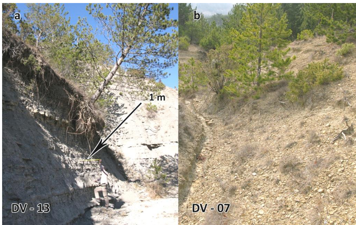
Slika 97 – Ogoline s različitim intenzitetom denudacijskih procesa; a) ogolina s visokim iznosima uzmicanja boka jaruge; b) ogoline obrasle vegetacijom u IG jedinici 3
