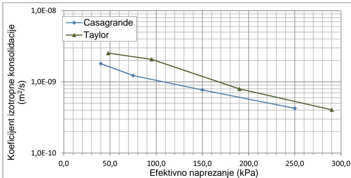
Slika 4-8 Ovisnost koeficijenta izotropne konsolidacije o efektivnim naprezanjima
