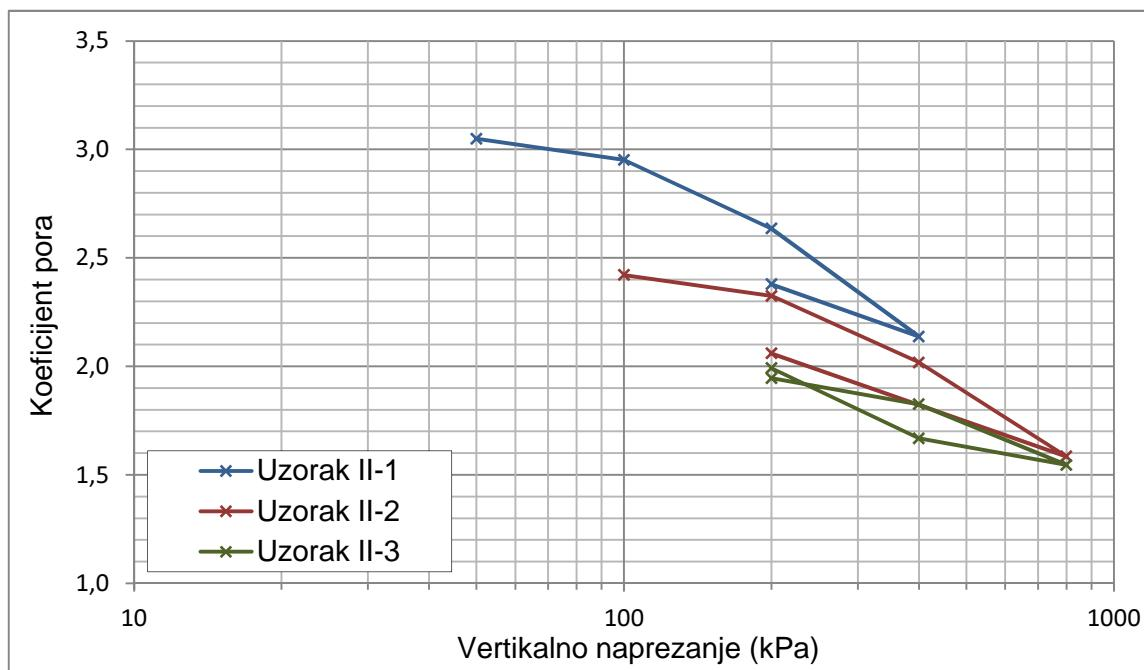
Slika 5-11 Ovisnost koeficijenta pora o normalnim efektivnim naprezanjima
