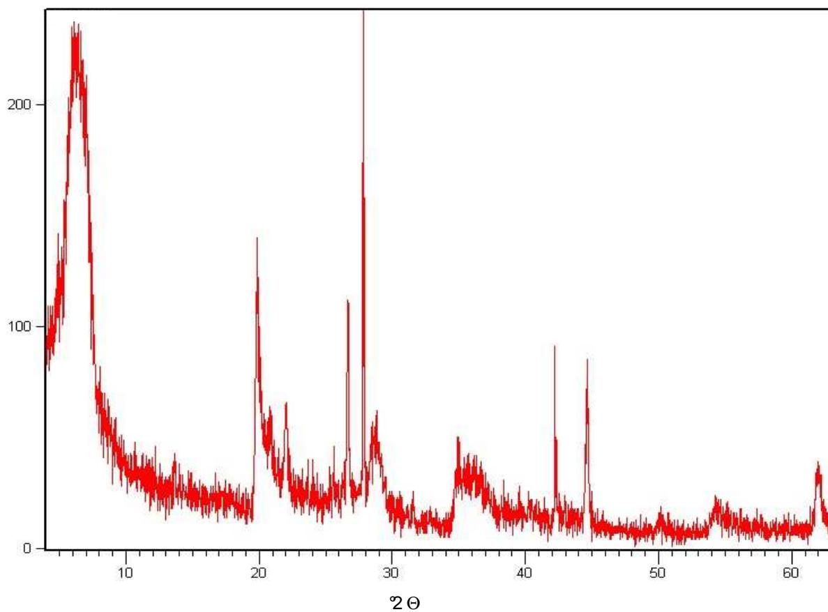
Slika 3-1 Difrakcijske linije originalnog, netretiranog uzorka
