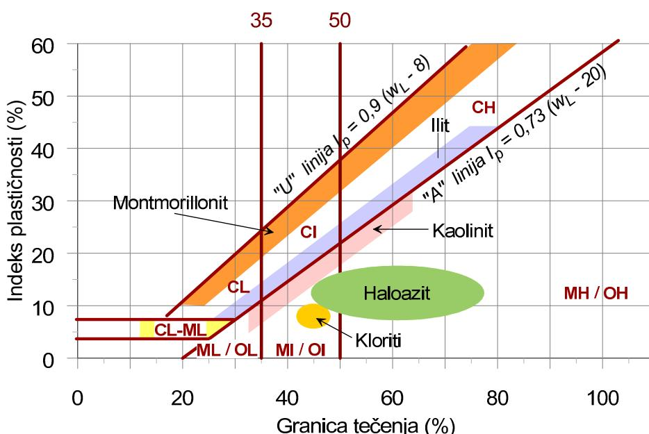
Slika 3-3 Dijagram plastičnosti (modificirano Holtz & Kovacs 1981)
