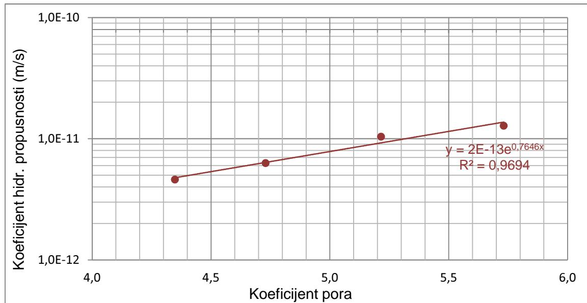
Slika 4-10 Ovisnost koeficijenta hidrauličke provodljivosti o koeficijentu pora
