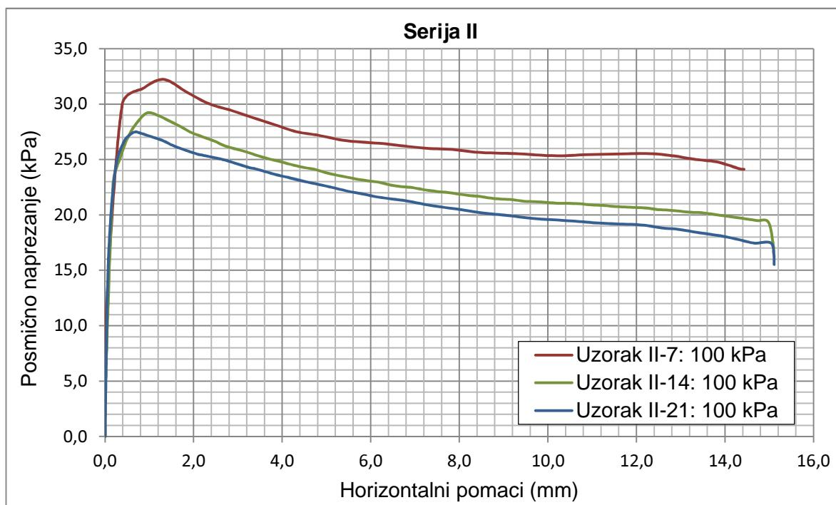
Slika 6-8 Ovisnost posmične čvrstoće o horizontalnim pomacima kod uzoraka opterećenih normalnim naprezanjem od 100 kPa
