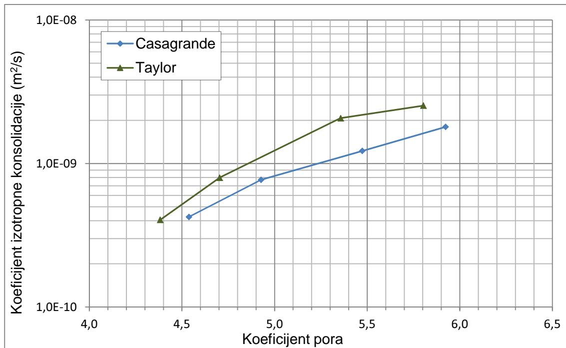
Slika 4-7 Ovisnost koeficijenta izotropne konsolidacije o koeficijentu pora
