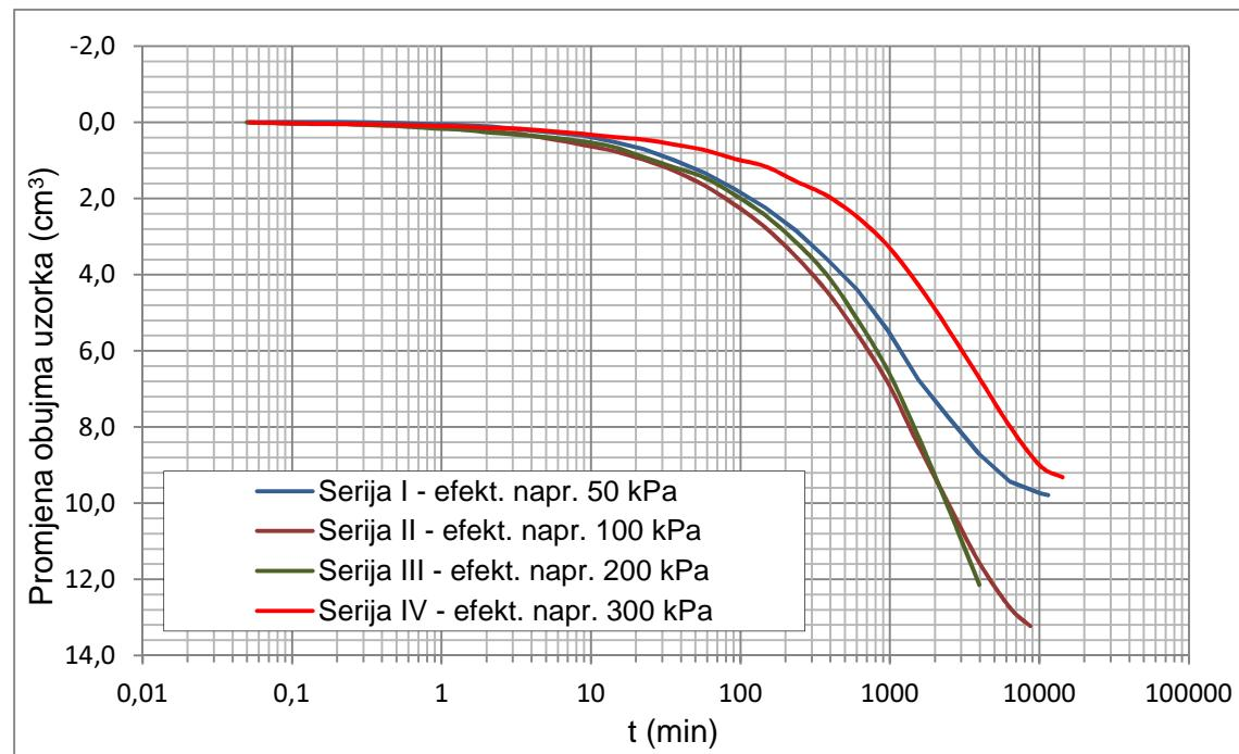
Slika 4-4 Promjena obujma uzorka u logaritamskom mjerilu vremena
