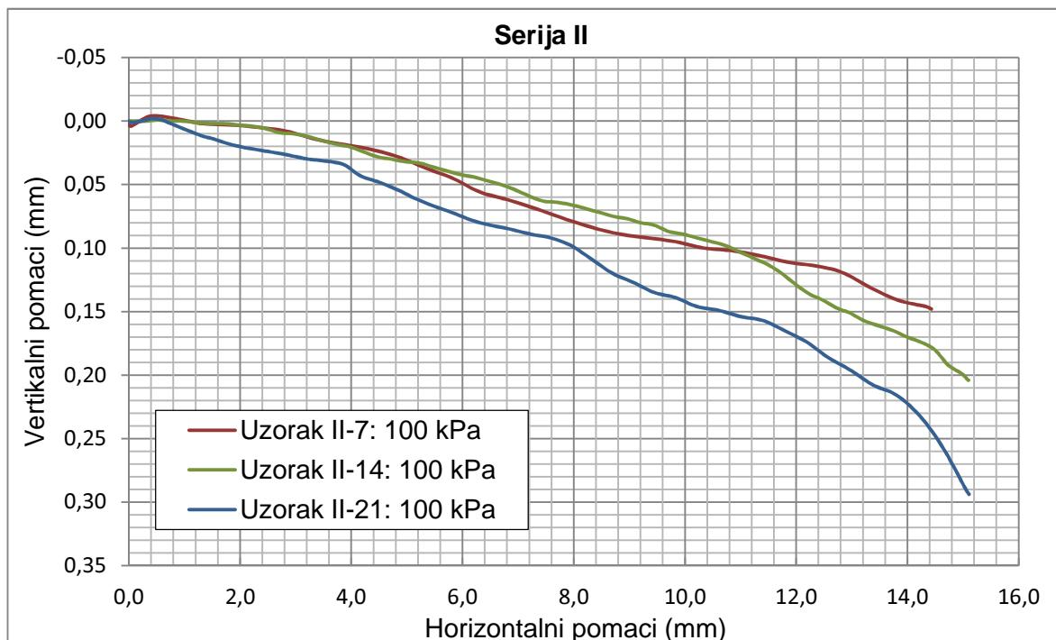
Slika 6-9 Ovisnost vertikalnih pomaka o horizontalnim pomacima kod uzoraka opterećenih normalnim naprezanjem od 100 kPa
