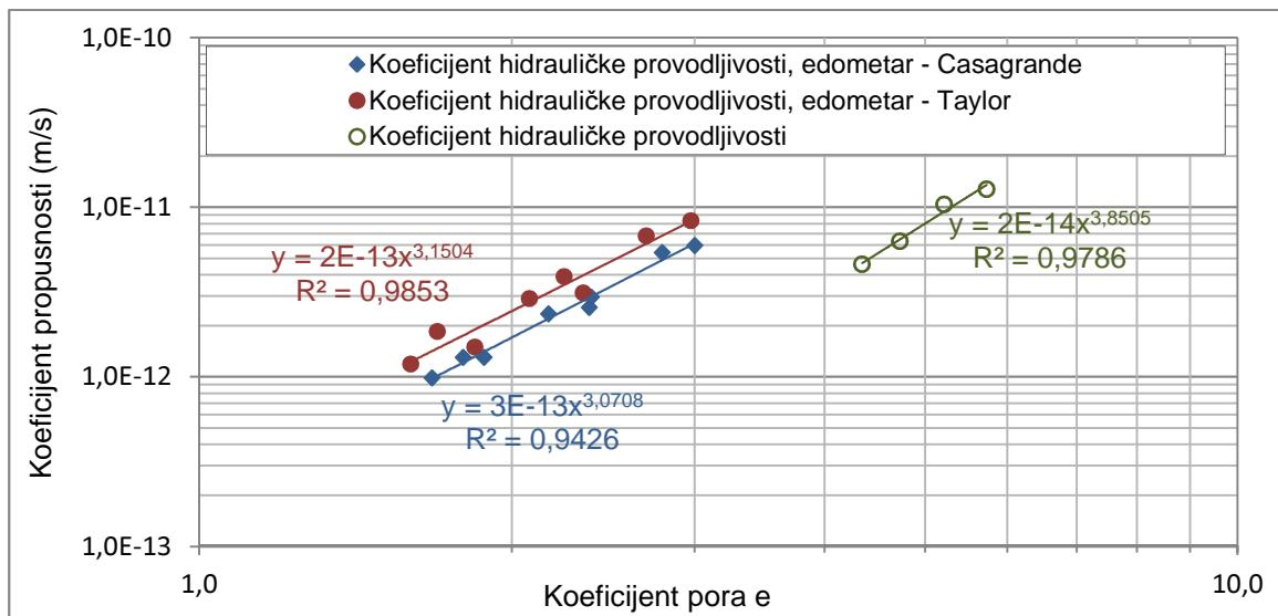
Slika 7-3 Utjecaj koeficijenta pora na koeficijente hidrauličke provodljivosti
