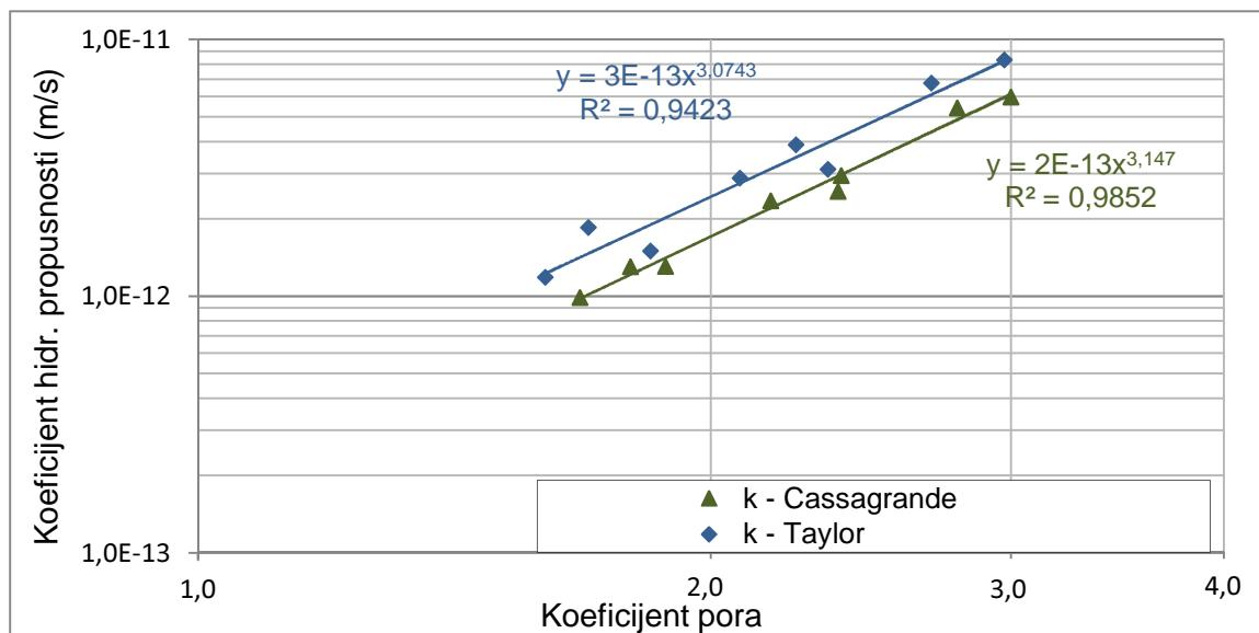
Slika 5-16 Ovisnost koeficijenta hidrauličke provodljivosti o koeficijentu pora
