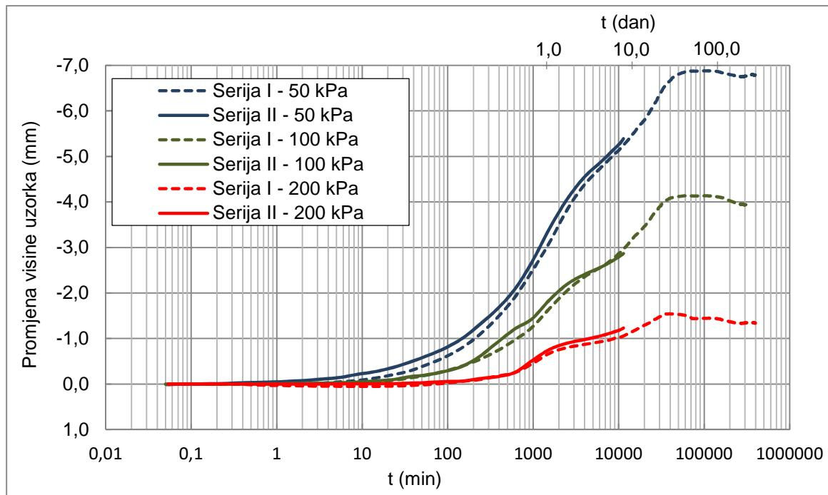
Slika 5-2 Promjene visine uzoraka u logaritamskom mjerilu vremena
