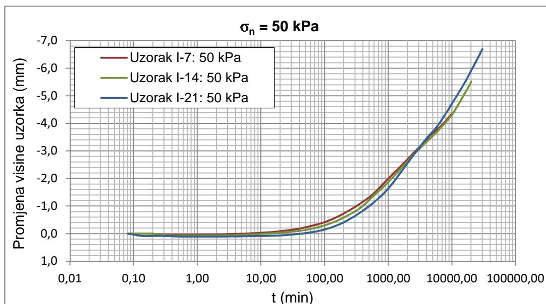
Slika 6-3 Promjene visine uzorka tijekom hidratacije uz normalno naprezanje  $\sigma_n = 50 \text{ kPa}$
