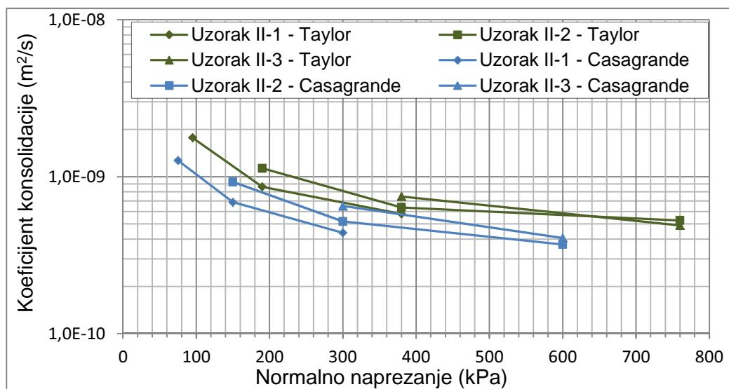
Slika 5-15 Ovisnost koeficijenta konsolidacije o efektivnim normalnim naprezanjima
