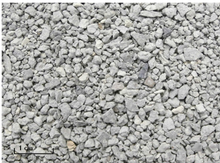
Slika 6-2 Reprezentativni uzorak bentonitne gline u formi granula
