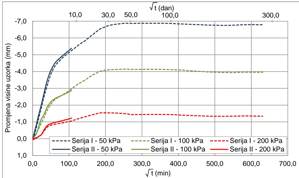
Slika 5-3 Promjene visine uzoraka u ovisnosti o  $\sqrt{t}$
