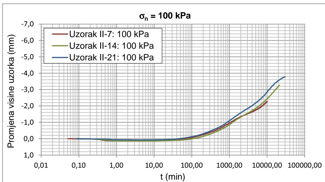
Slika 6-4 Promjene visine uzoraka tijekom hidratacije uz normalno naprezanje  $\sigma_n = 100 \text{ kPa}$
