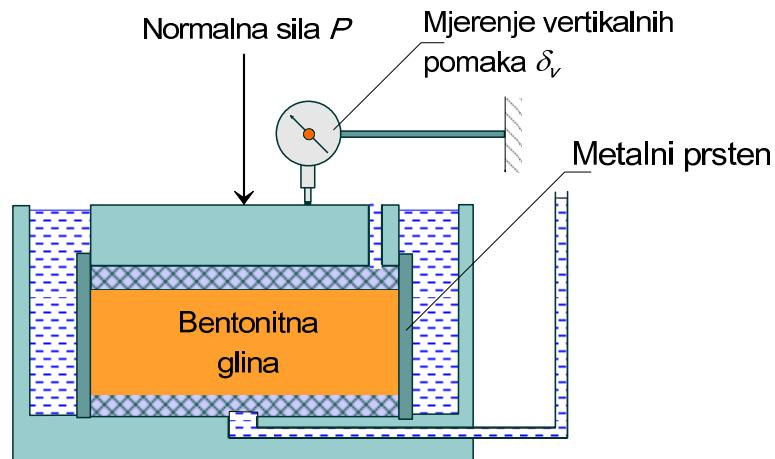
Slika 5-1 Poprečni presjek edometarske čelije
