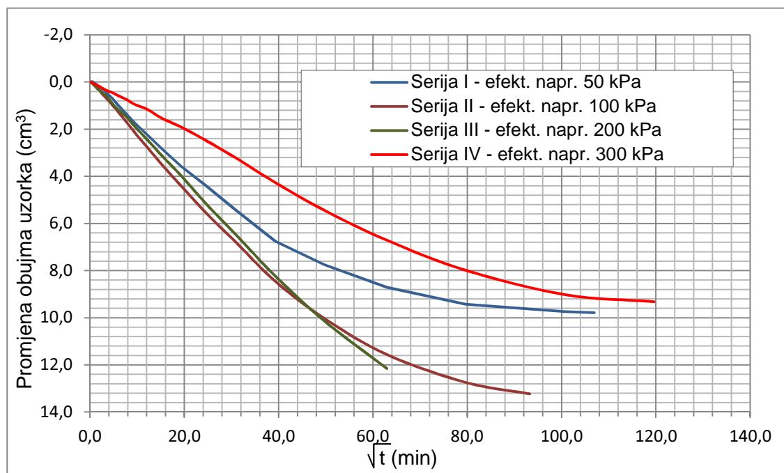
Slika 4-5 Promjena obujma uzorka u ovisnosti o  $\sqrt{t}$
