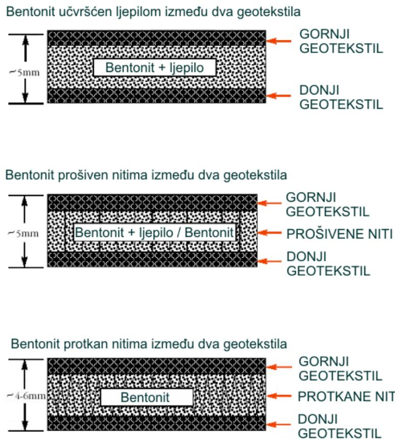
Slika 2-9 Načini spajanja bentonitne gline i geotekstila
