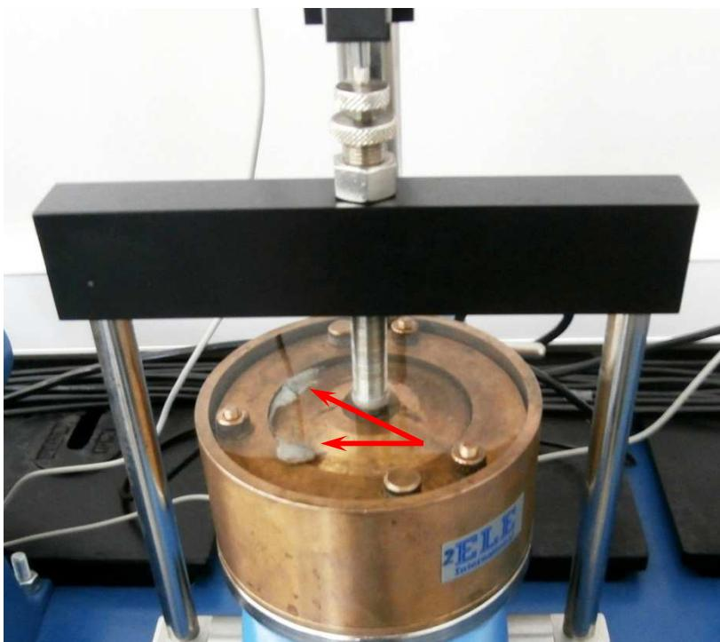
Slika 5-12 Istiskivanje uzorka iz edometarske čelije
