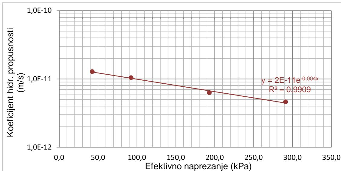
Slika 4-9 Ovisnost koeficijenta hidrauličke provodljivosti o efektivnim naprezanjima
