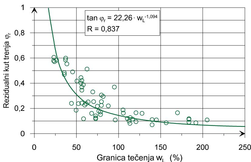
Slika 2-26 Funkcijska veza rezidualnog kuta trenja i granice tečenja dobivena na temelju 145 uzorka tla smektitima kao dominantnim mineralom (Suzuki et al. 2005)
