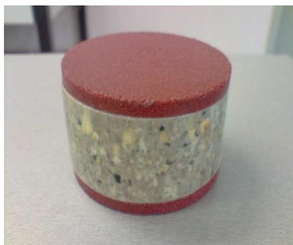
Slika 4-2 Uzorak pripremljen za ugradnju u troosnu čeliju
