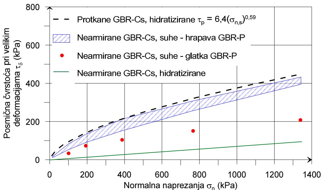
Slika 2-11 Rezidualne vrijednosti posmične čvrstoće suhih i hidratiziranih nearmiranih glinenih geosintetičkih brijera pri različitim normalnim naprezanjima (modificirano iz Chiu & Fox 2004)
