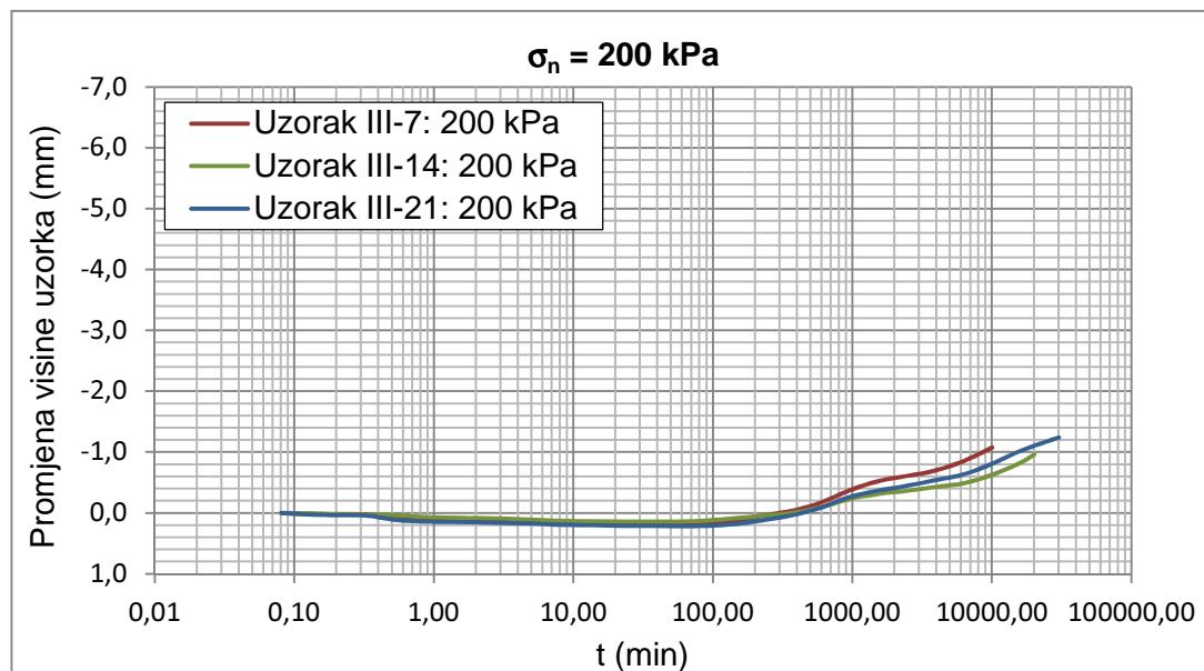
Slika 6-5 Promjene visine uzoraka tijekom hidratacije uz normalno naprezanje  $\sigma_n = 200 \text{ kPa}$
