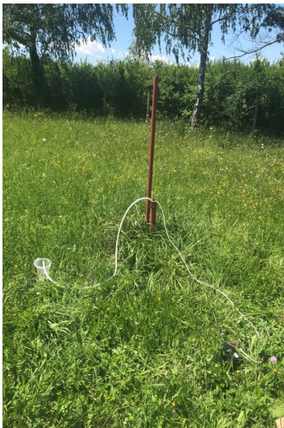
Slika 3.3. Uzimanje uzorka podzemne vode iz piezometra P-61
