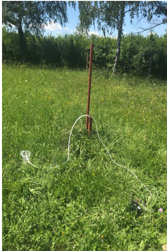
Slika 3.3. Uzimanje uzorka podzemne vode iz piezometra P-61
