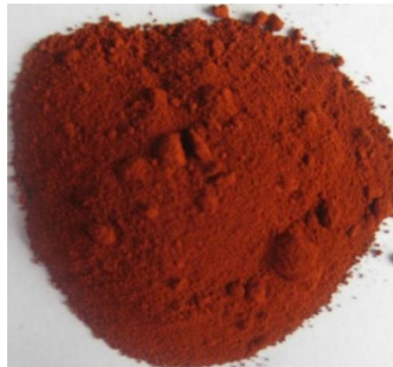
Slika 4-5. Nanočestice Fe 2 O 3 u obliku praha ( www.what-is-nanotechnology.com )
