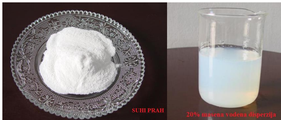
Slika 4-3. Nanočestice Al 2 O 3 u obliku praha (lijevo) i nanočestice Al 2 O 3 suspendirane u vodi (desno) ( www.s.b5z.net/i/u/10091461/i/US3004-big.jpg )
