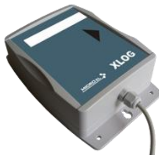
Slika 3-2. XLOG GSM/GPRS prikupljač podatka s baterijskim pogonom (MICRO EL, 2012.)
