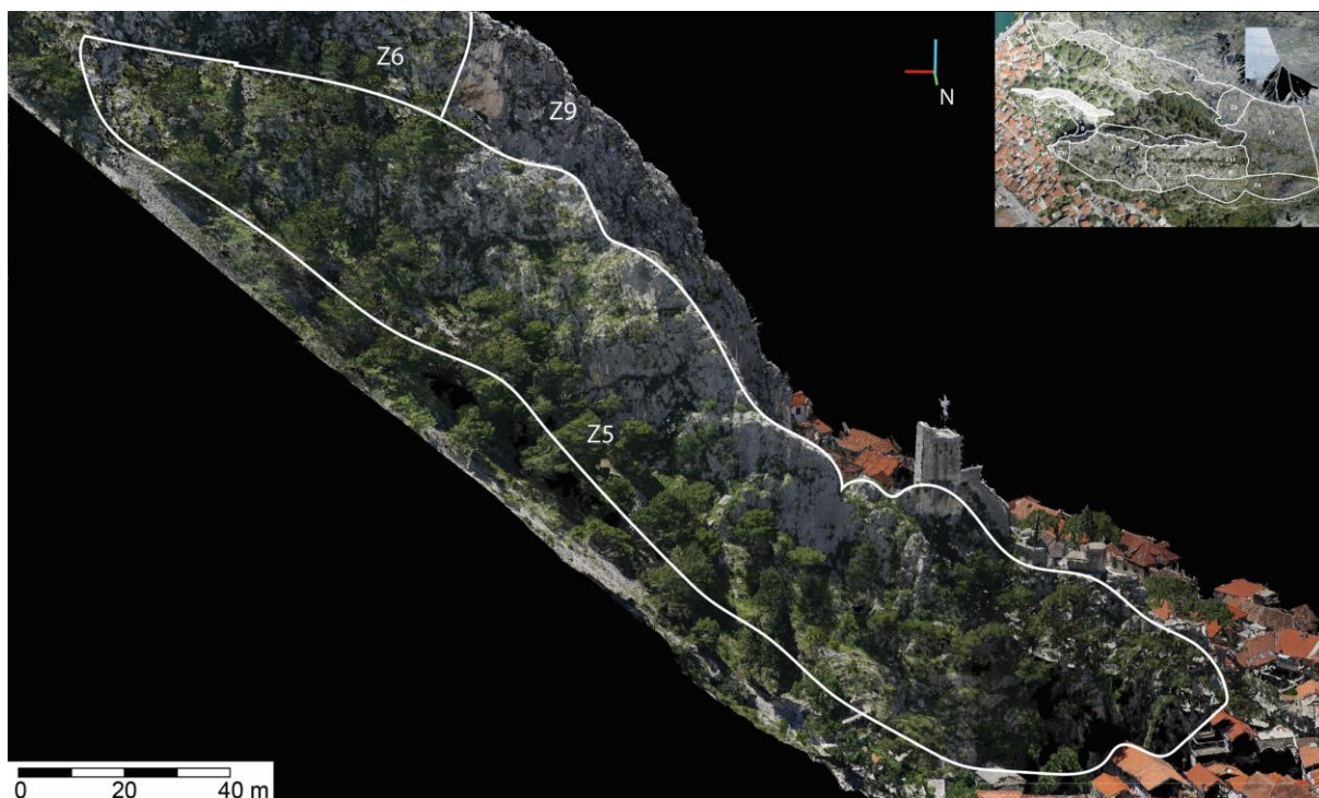
Slika 5.14. Pogled na inženjerskogeološku zonu Z5 s ucrtanim granicama inženjerskogeoloških zona Z5, Z6 i Z9 na visoko-rezolucijskom digitalnom modelu istraživanih stijenskih kosina.
