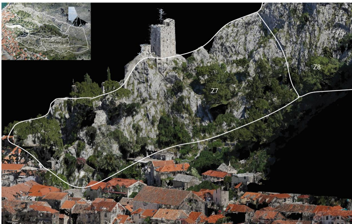
Slika 5.20. Pogled na inženjerskogeološku zonu Z7 s ucrtanim granicama inženjerskogeoloških zona Z7 i Z8 na visoko-rezolucijskom digitalnom modelu istraživanih stijenskih kosina.
