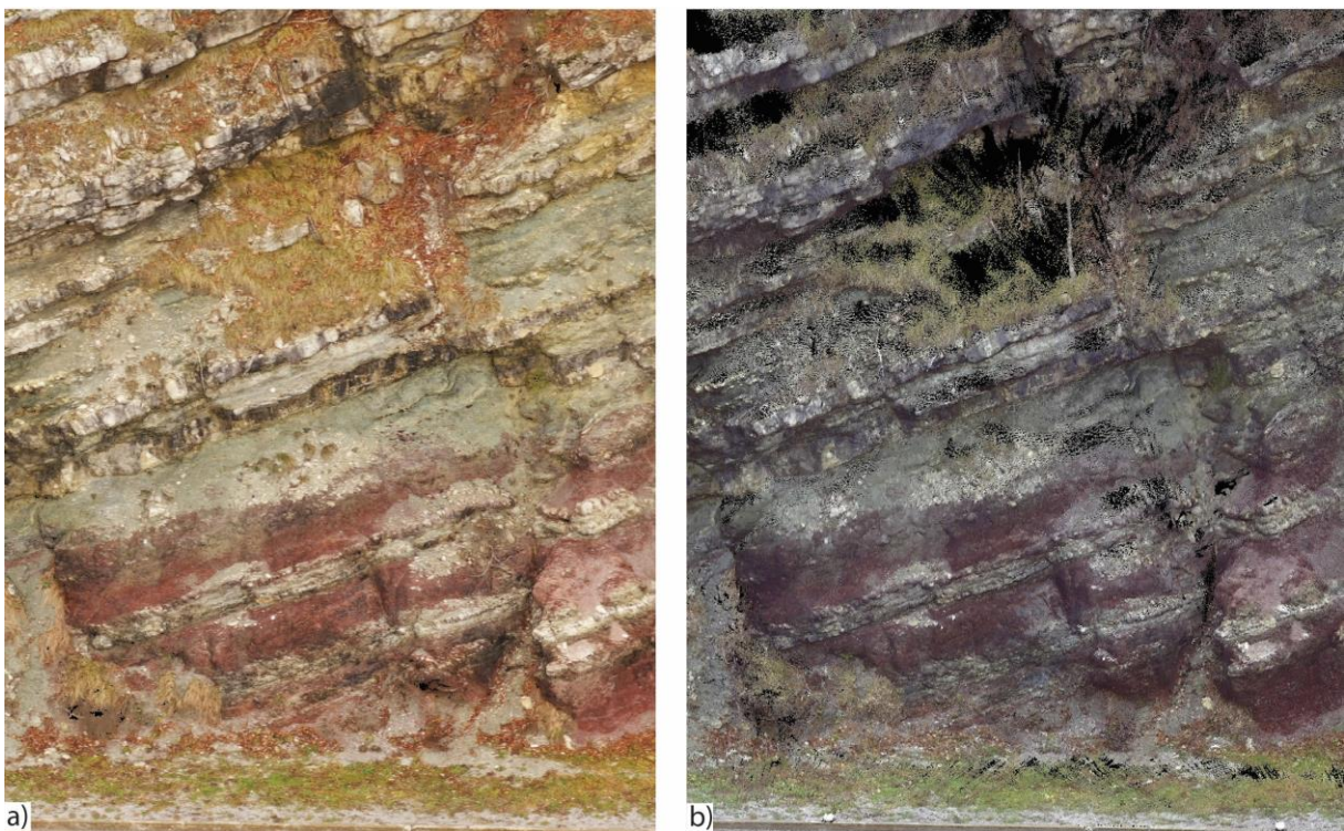
Slika 4.8. Vizualna usporedba visoko-rezolucijskih modela oblaka točaka dijela stijenskog zasjeke u Lokvama dobivenih: a) fotogrametrijskim snimanjem iz zraka bespilotnom letjelicom i b) TLS-om.
