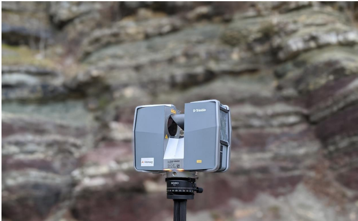
Slika 4.5. Fotografija terestričkog laserskog skeniranja stijenskog zasjea u Lokvama s Trimble TX5 TLS-om.
