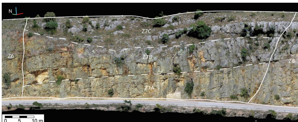
Slika 5.52. Pogled prema SI na inženjerskogeološke zone Z7A, Z7B i Z7C s ucrtanim granicama zone na visokorezolucijskom digitalnom modelu istraživanih stijenskih kosina.
