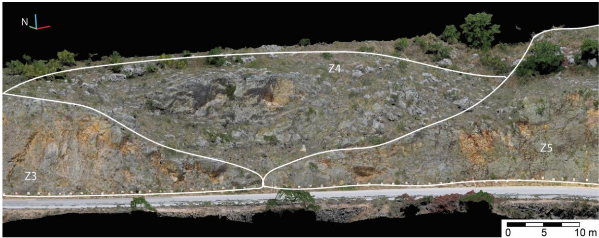
Slika 5.43. Pogled prema SI na inženjerskogeološku zonu Z4 i djelove susjednih zona Z3 i Z5 s ucrtanim granicama zona na visoko-rezolucijskom digitalnom modelu istraživanih stijenskih kosina.
