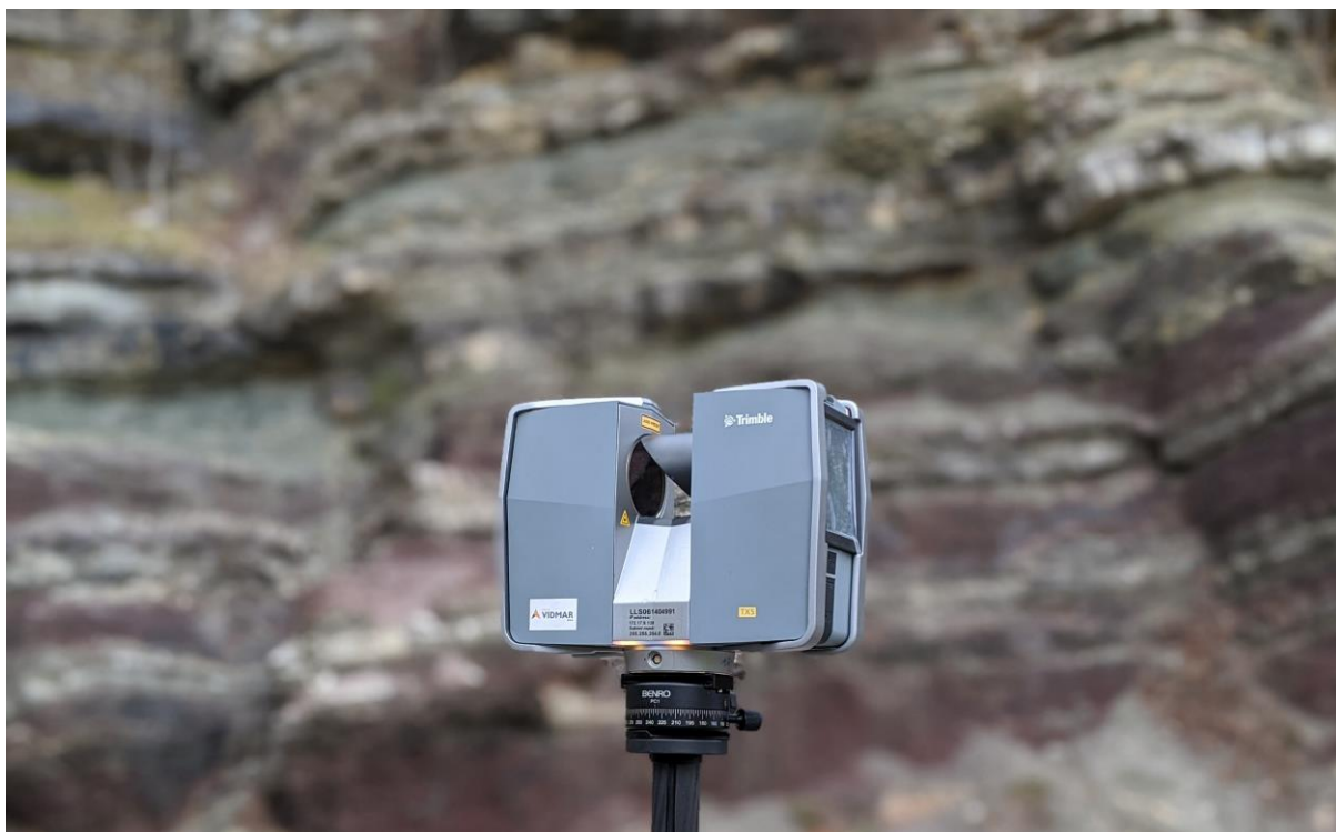
Slika 4.5. Fotografija terestričkog laserskog skeniranja stijenskog zasjea u Lokvama s Trimble TX5 TLS -om.
