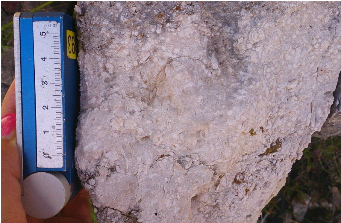
Slika 5-24. Foraminiferski vapnenac s alveolinama i numulitima.
