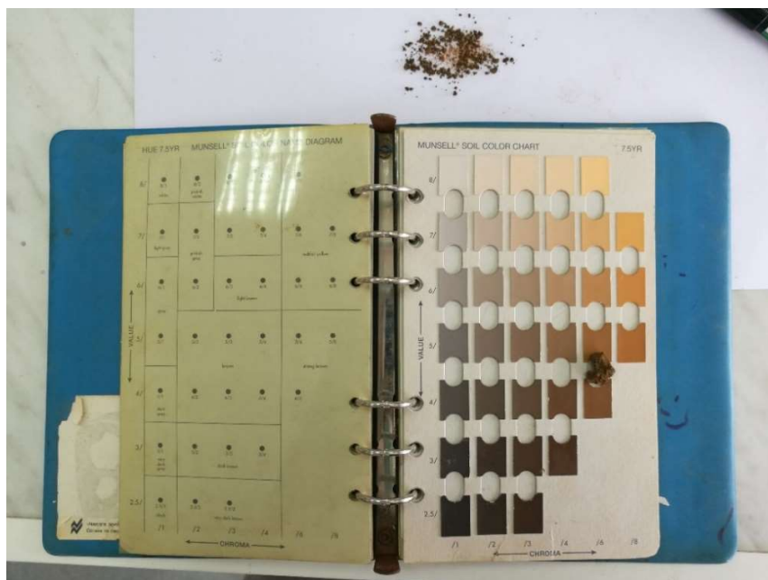
Slika 4. Određivanje boje uzorka uz pomoć Munsellovog atlasa boja
