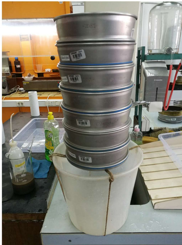
Slika 7. Set sita prema Wentworthovoj skali
