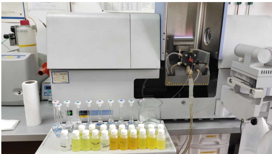
Slika 12. Mjerenje elemenata plamenom tehnikom na atomskom spektrometru Perkins Elmer AAAnalyst 700 (foto: Adelita Skitarelić)
