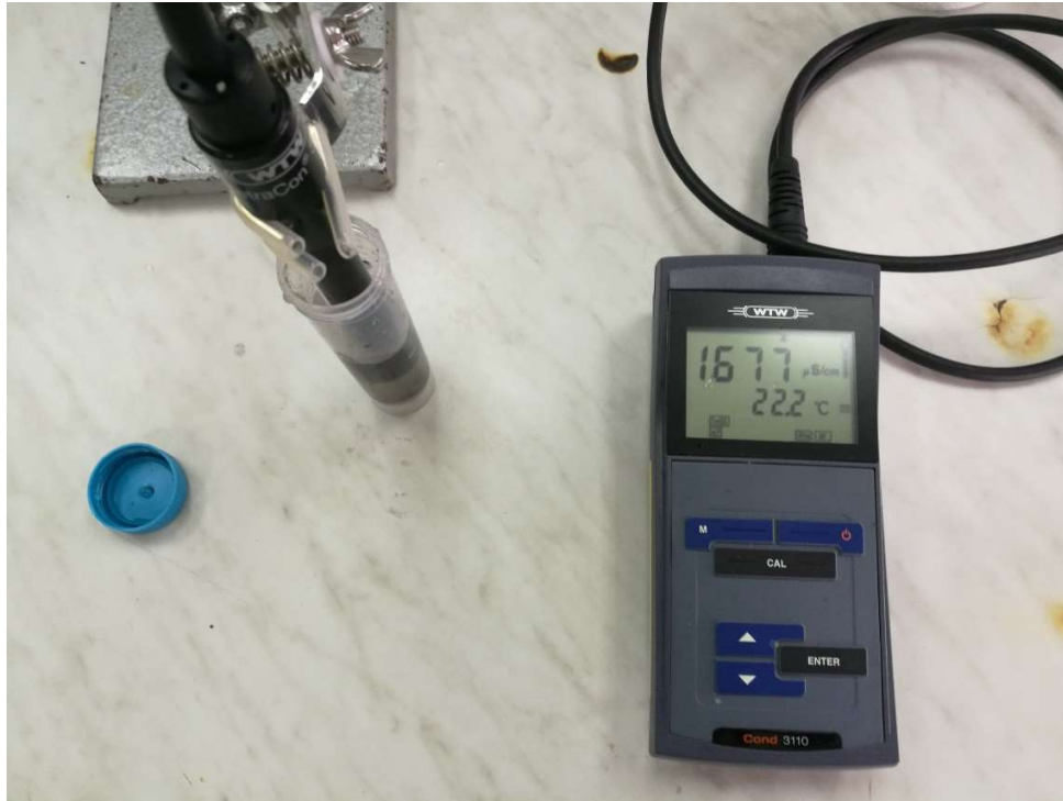
Slika 6. Određivanje električne vodljivosti tla uređajem WTW Cond 3110
