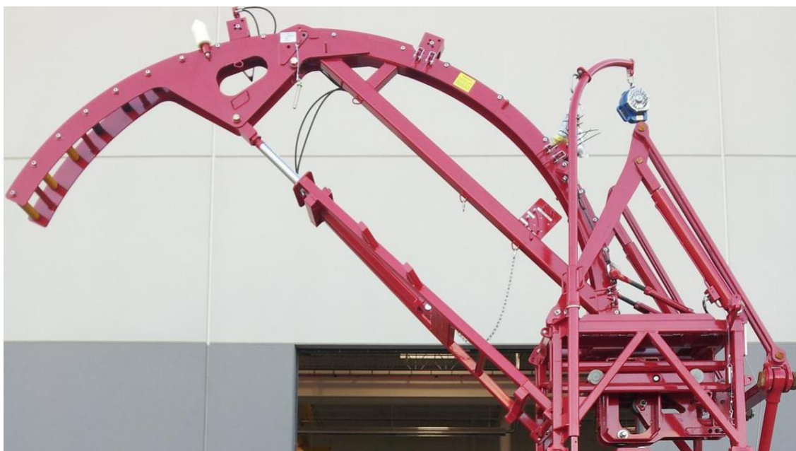
Slika 3-6. Vodilica savitljivog tubinga (Harestad, 2019)
