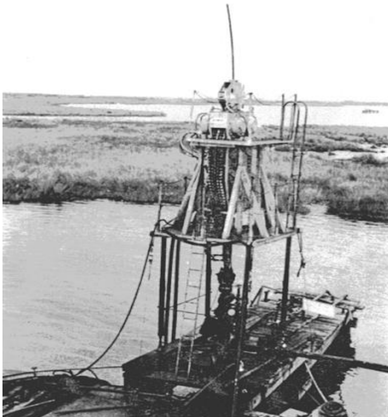
Slika 2-2. Injektorska glava kompanije Bowen Tools (Coil solutions, 2016)
