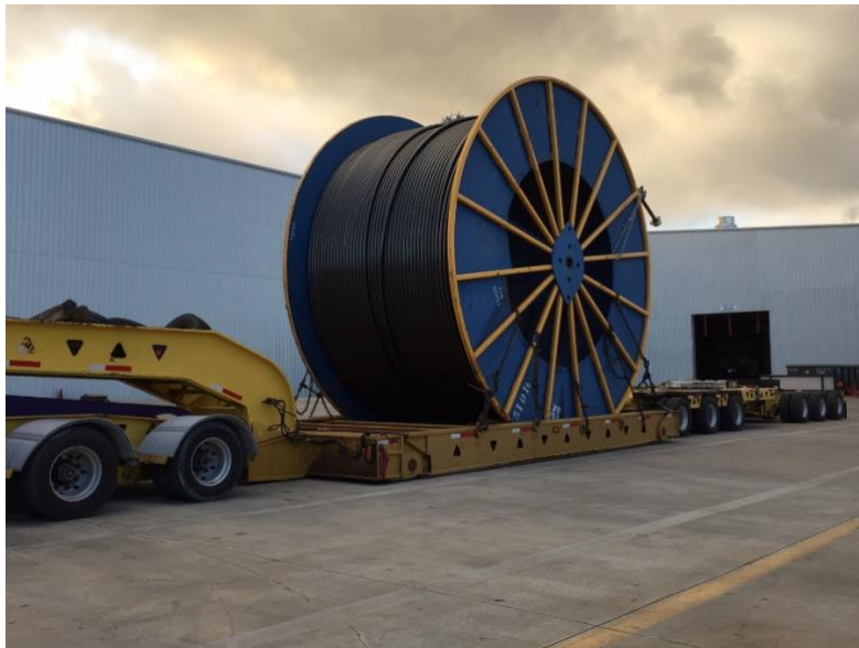
Slika 2-9. Savitljivi tubing namotan na bubanj (World Oil, 2016)
