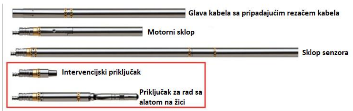
Slika 5-3. Sastav dubinskih alatki za primjenu na hibridnom sustavu koji uključuje savitljivi tubing i hibridni kabel (Equion et al., 2020)
