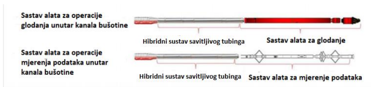
Slika 5-4. Otvorena konstrukcija dubinskih alatki hibridne tehnologije savitljivog tubinga (Higuera et al., 2020)
