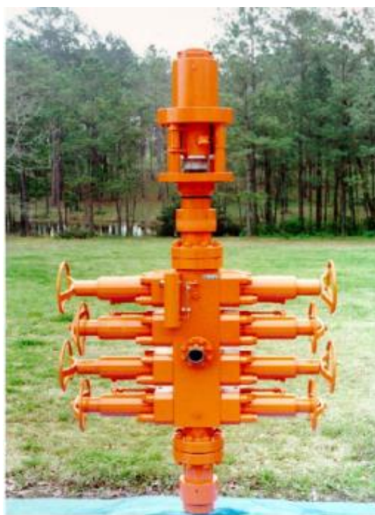
Slika 3-9. Preventerski sklop s četverostrukim čeljusnim preventerima i striperom s bočnim otvorom (Ctes, 2005)
