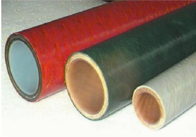
Slika 2-3. Savitljivi tubing od kompozitnog materijala (Ctes, 2005)
