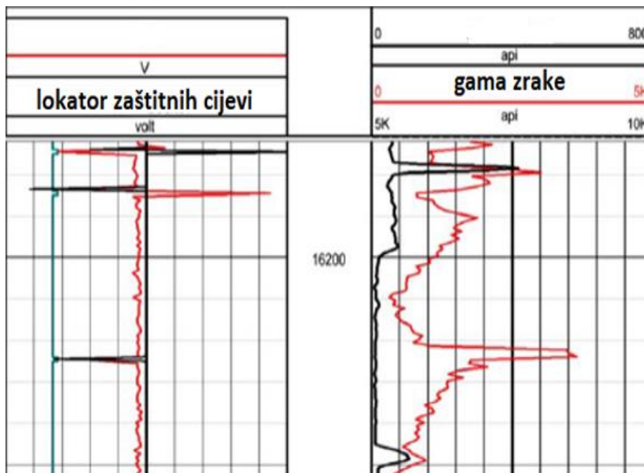
Slika 5-11. Korelacija dubine uz pomoć lokatora zaštitnih cijevi i gama zraka (Delgado et al., 2019b)
