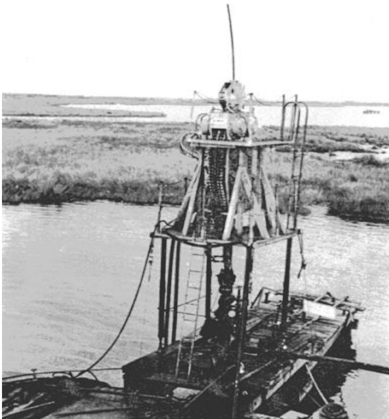
Slika 2-2. Injektorska glava kompanije Bowen Tools (Coil solutions, 2016)
