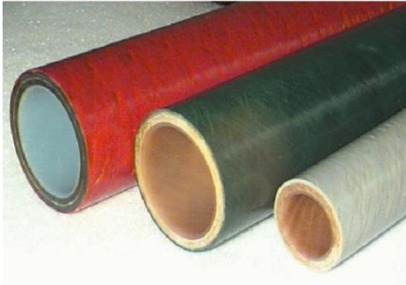
Slika 2-3. Savitljivi tubing od kompozitnog materijala (Ctes, 2005)
