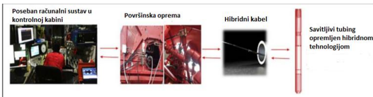
Slika 5-1. Savitljivi tubing opremljen hibridnom tehnologijom (Equion et al., 2020)
