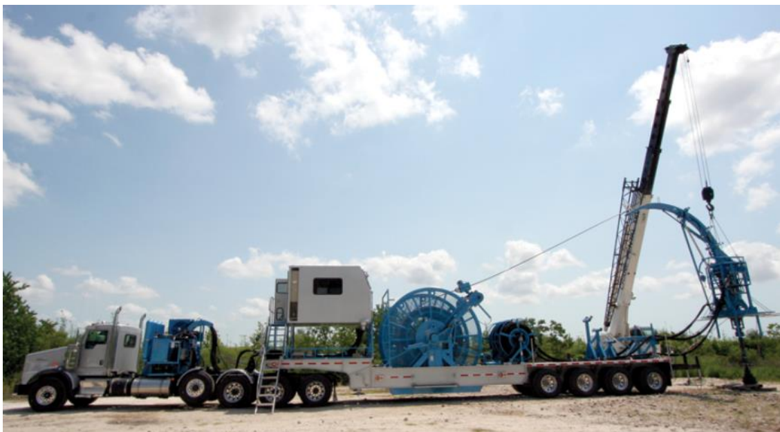
Slika 3-1. Postrojenje za rad sa savitljivim tubingom montirano na prikolici koje se uglavnom koristi za kopnene operacije (Drilling formulas.com, 2016)
