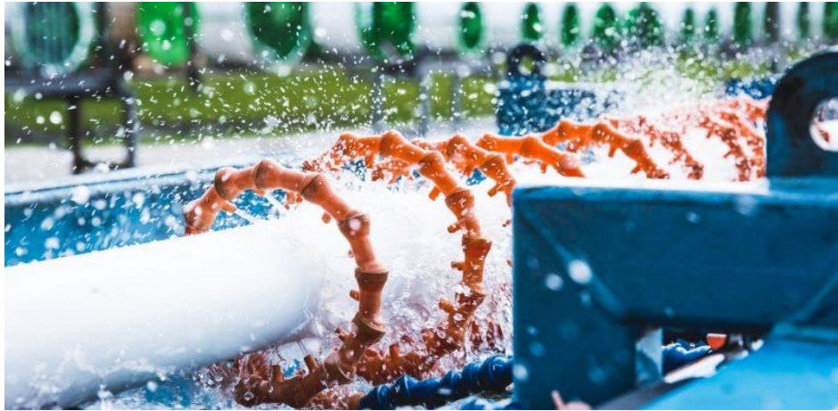
Slika 2-8. Hlađenje savitljivog tubinga uz pomoć tekuće kupke (Manufacturing best practices, 2018)
