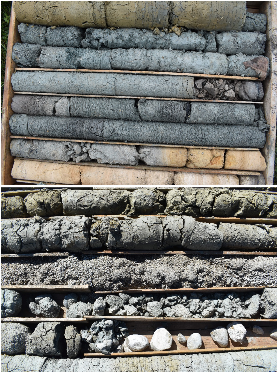
Slika 2.7 Jedan dio fotografija jezgre bušotine B1.
