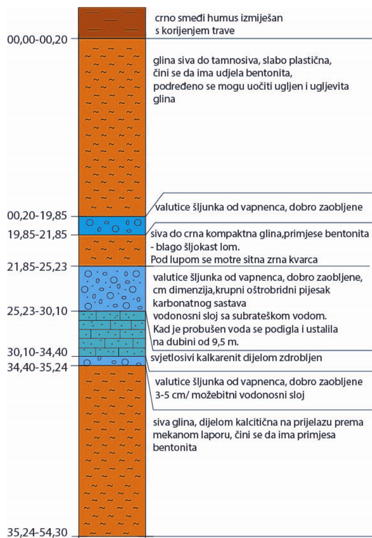
Slika 2.5 Litologija jezgre istražno piezometarske bušotine B1 Ekonomija Jajce.
