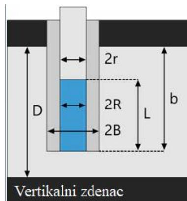
Slika 6.1 Prikaz vertikalnog zdenca i njegovih parametara
