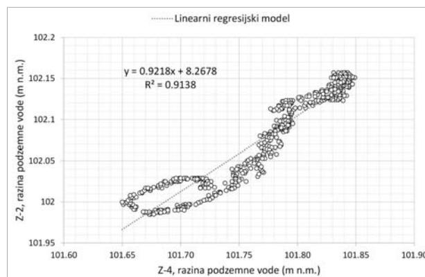
**Slika 4.5.** Regresijska analiza vremenskih nizova razina podzemne vode izmjerjenih u piezometru Z-4 i zdencu Z-2.
