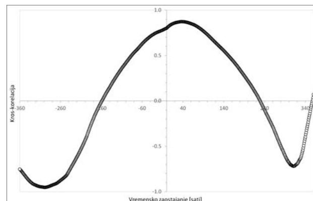
**Slika 4.6.** Kros-korelogram satnih mjerjenja razina podzemne vode u piezometru Ž-8 i zdencu Z-1. Maksimalna pozitivna korelacija pojavljuje se za vremensko zaostajanje od 36 sati.
