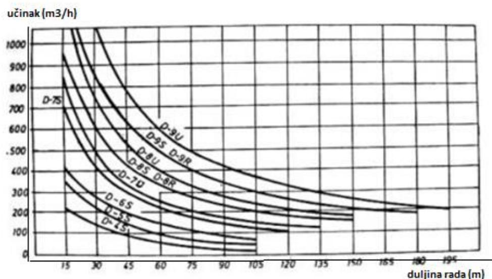
**Slika 3.6** Dijagram ovisnosti kapaciteta buldozera o duljini trase
