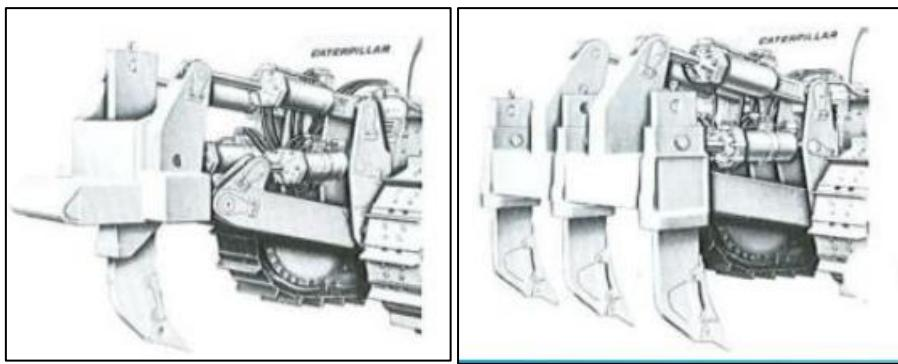
**Slika 3.5** Shema ripera s jednim (lijevo) i s tri zuba (desno)
