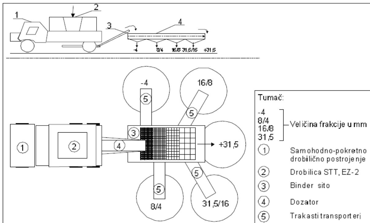
Slika 3.12 Shema postrojenja za sitnjenje i klasiranje tehničko-građevnog kamenja (Galić, 2004)
