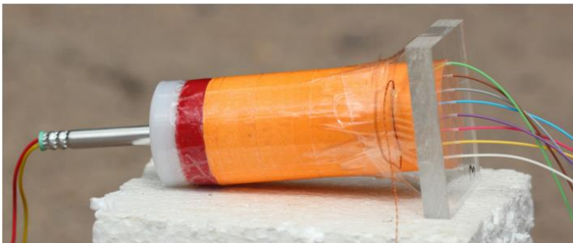
Slika 3-15. Raspored osjetila po promjeru eksploziva (Pachman, 2019)
