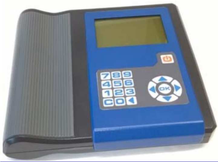
Slika 3-4. Uređaj Optimex 8 za mjerenje brzine detonacije i zakrivljenosti detonacijskog vala (Kubiček, 2015)
