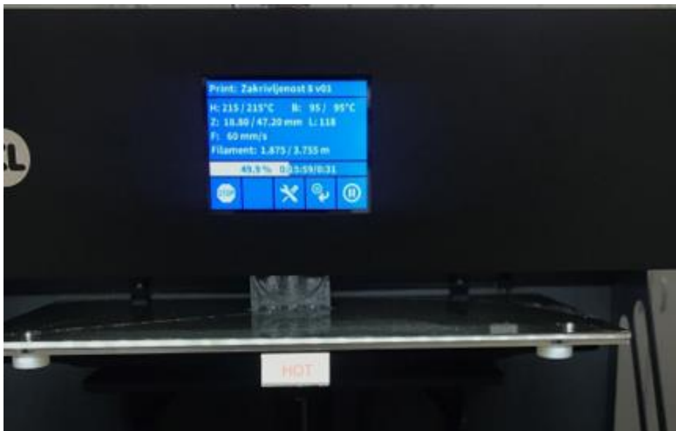
Slika 4-21. Prikaz izrade čepa na 3D printeru sa parametrima izrade
