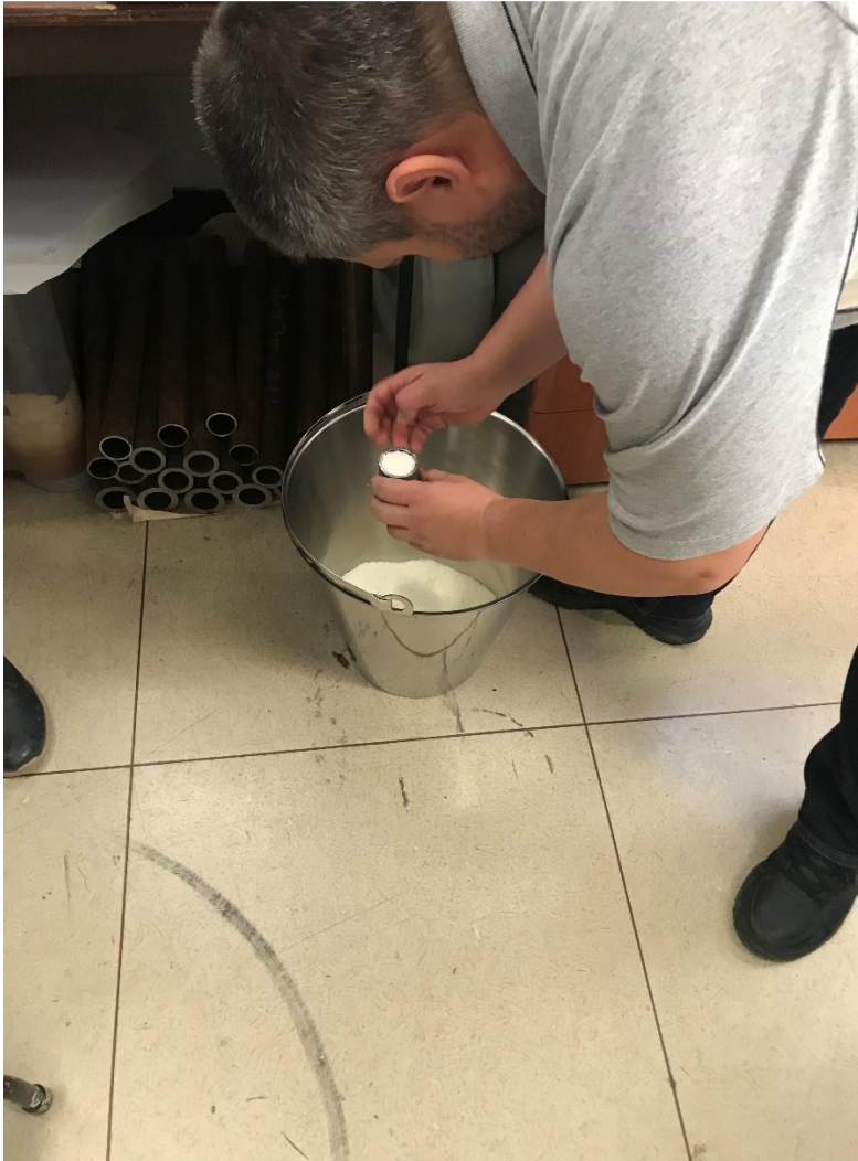
Slika 4-22. Punjenje uzorka ANFO eksplozivom
