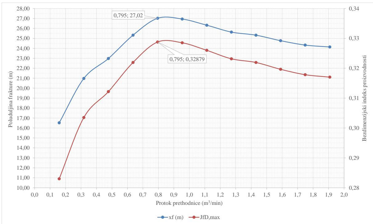
Slika 45. Zavisnost kretanja vrijednosti maksimalnih poluduljina frakture i odnosnih teoretski maksimalnih bezdimenzijskih indeksa proizvodnosti u funkciji protoka prethodnice za ležiste PLQ-F bušotine SJ – 2 Dir.
