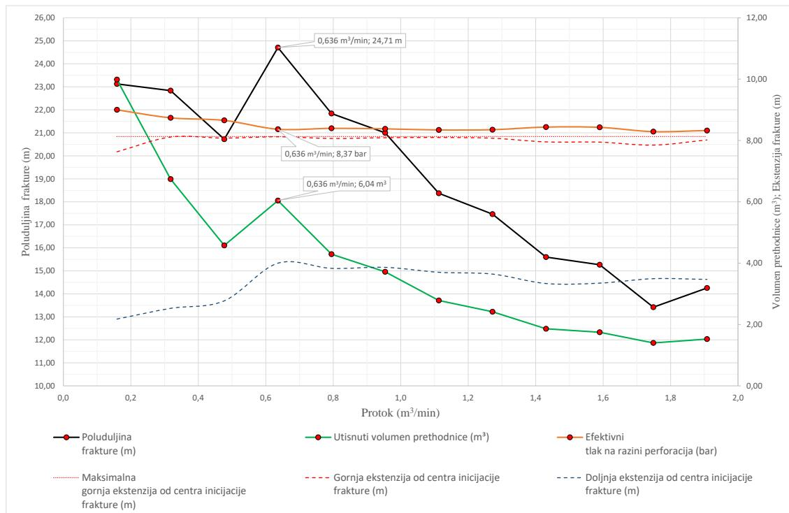
Slika 54. Dijagram ravnotežnih odnosa maksimalno ostvarenih poluduljina frakture, efektivnog tlaka i volumena prethodnice u funkciji veličine protoka prethodnice za ležište PLQ-F bušotine SJ – 1 Dir.
