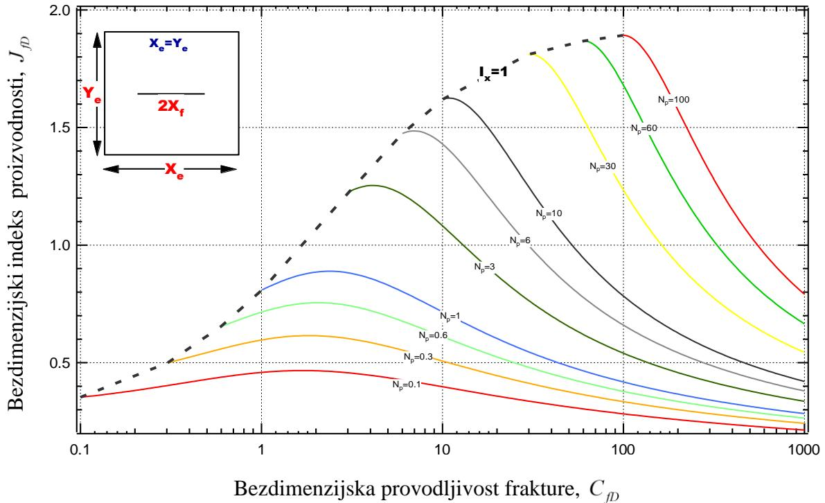
Slika 11. Bezdimenzijski indeks proizvodnosti  $J_{fD}$  kao funkcija bezdimenzijske provodljivosti frakture  $C_{fD}$  i broja podupirača  $N_{prop}$ , za  $N_{prop} \geq 0,1$ , preuzeto iz Valko (2006).
