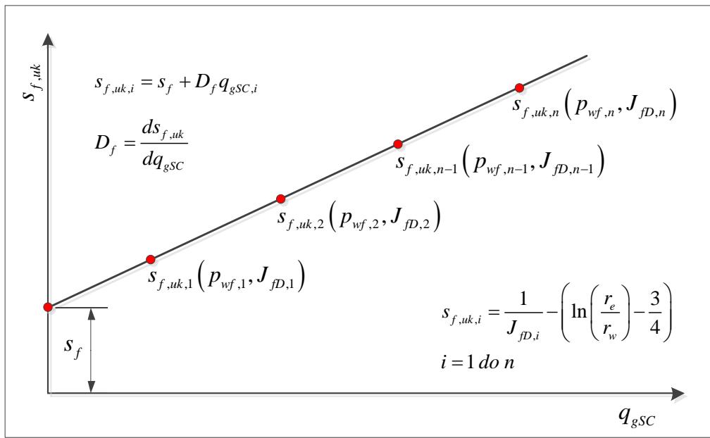
Slika 15. Grafički prikaz određivanja ekvivalentnog linearne skine uslijed frakturiranja  $s_f$  i ekvivalentnog efekta visokih brzina protjecanja fluida u frakturi  $D_f$ .
