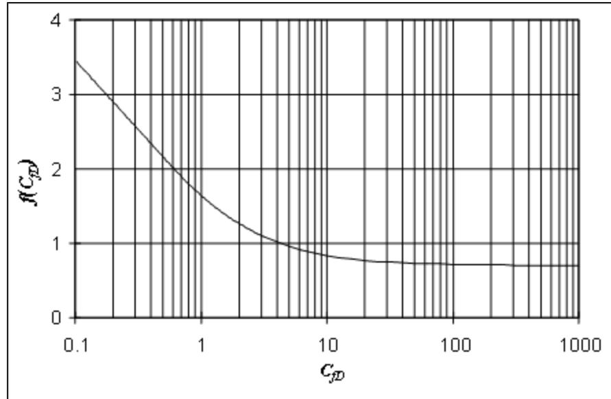
Slika 5. Korelativni odnos bezdimenzijske provodljivost frakture  $C_{fd}$  i funkcije  $f(C_{fd})$  (Cinco-Ley i Samaniego, 1981).
