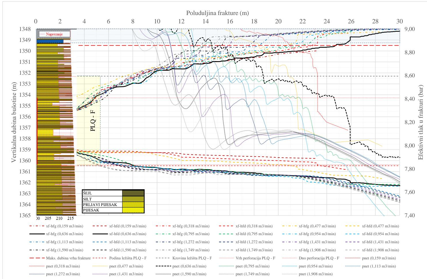
Slika 67. Dijagram ravnotežnih odnosa geometrije frakture u funkciji veličine protoka prethodnice ležišta PLQ-F bušotine SJ - Dir
