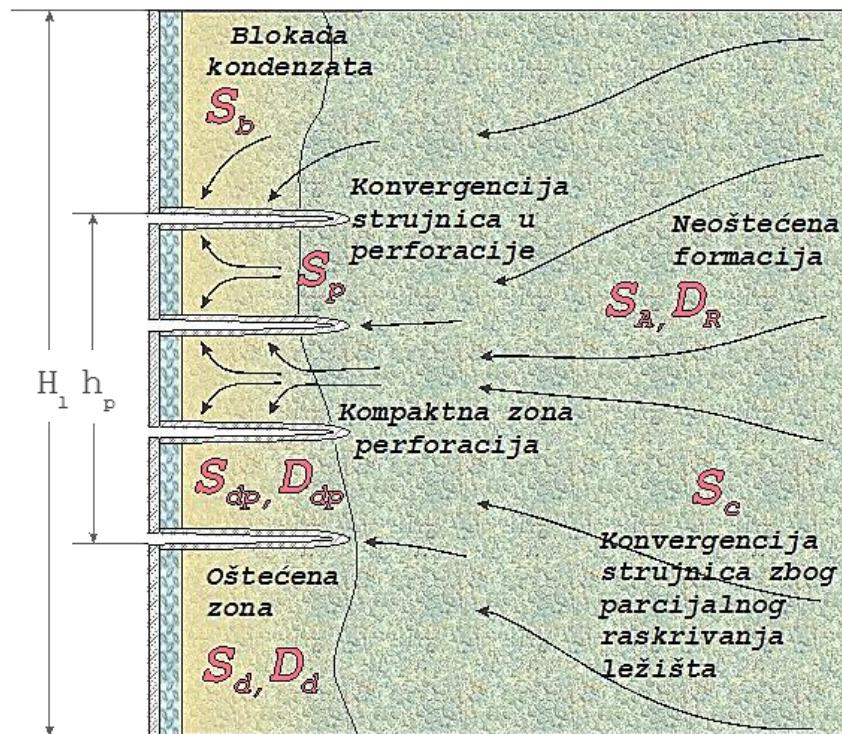
Slika 4. Pojednostavljeni prikaz strujnog toka fluida i karakterističnih *skin* efekata konvencionalno zacjevljene bušotine s perforacijama u području ležišta bez pješčanog zasipa.
