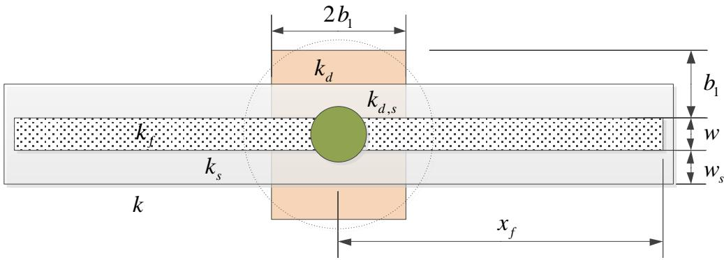
Slika 13. Model kombiniranog skina uslijed oštećenja lica frakture i oštećenja pribušotinske zone prema (Mathur et al., 1995).
