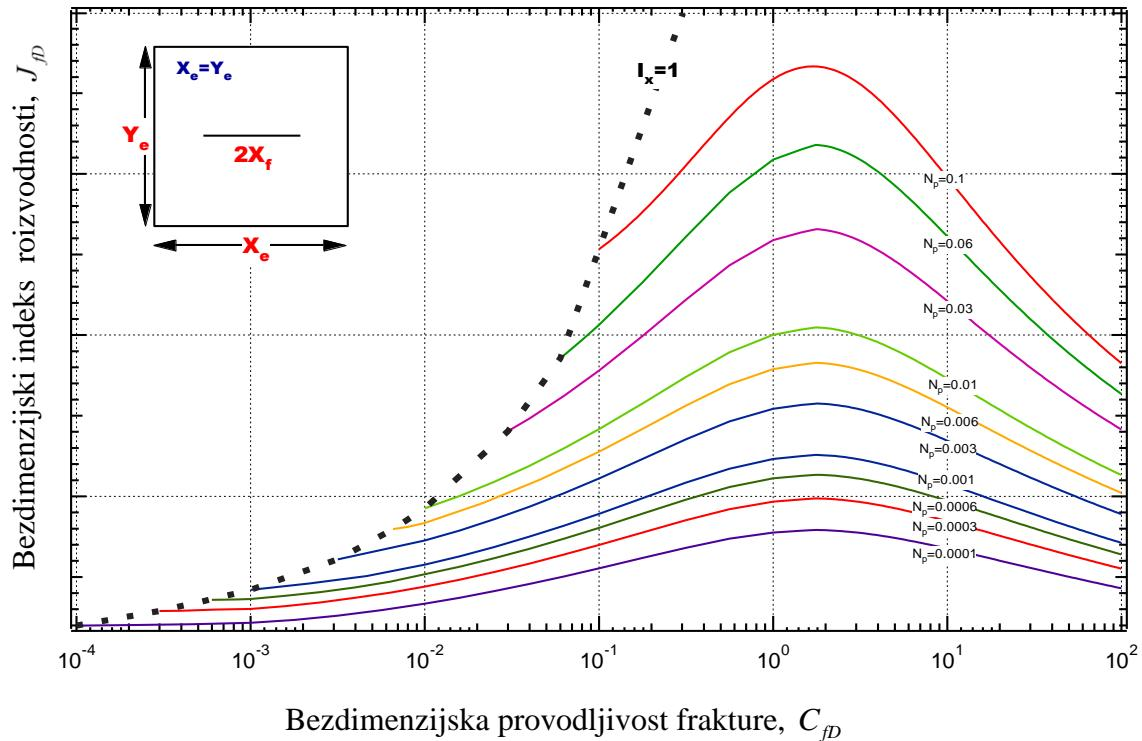
Slika 10. Bezdimenzijski indeks proizvodnosti  $J_{FD}$  kao funkcija bezdimenzijske provodljivosti frakture  $C_{FD}$  i broja podupirača  $N_{prop}$ , za  $N_{prop} \leq 0,1$ , preuzeto iz Valko (2006).
