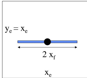
Slika 8. Model vertikalne frakture unutar kvadratnog drenažnog volumena, preuzeto iz Valko (2006).
