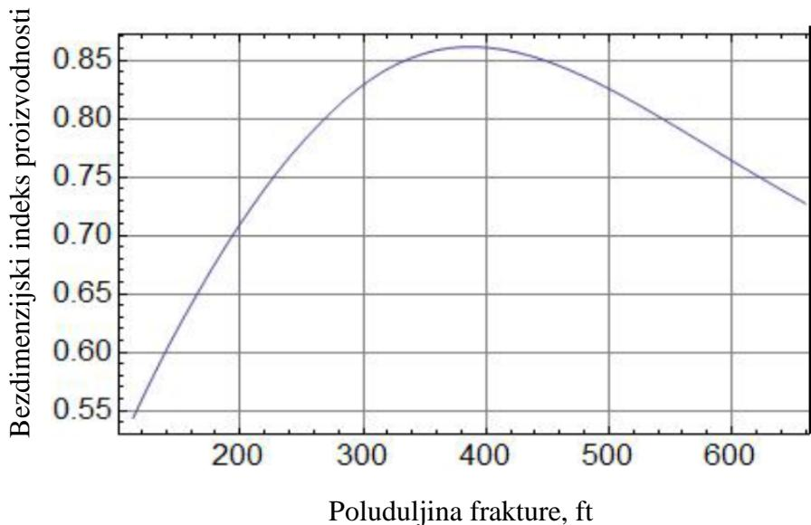
Slika 22. Graf zavisnosti optimalnih poluduljina frakture i bezdimenzijskog indeksa proizvodnosti, preuzeto iz Yang et al. (2012).
