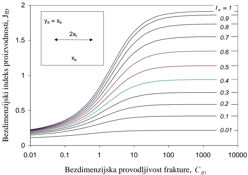
Slika 9. McGuire & Sikora (1960) prezentacija bezdimenzijskog indeksa proizvodnosti  $J_{FD}$  kao funkcije bezdimenzijske provodljivosti frakture i penetracijskog odnosa  $I_x$ , preuzeto iz Valko (2006).
