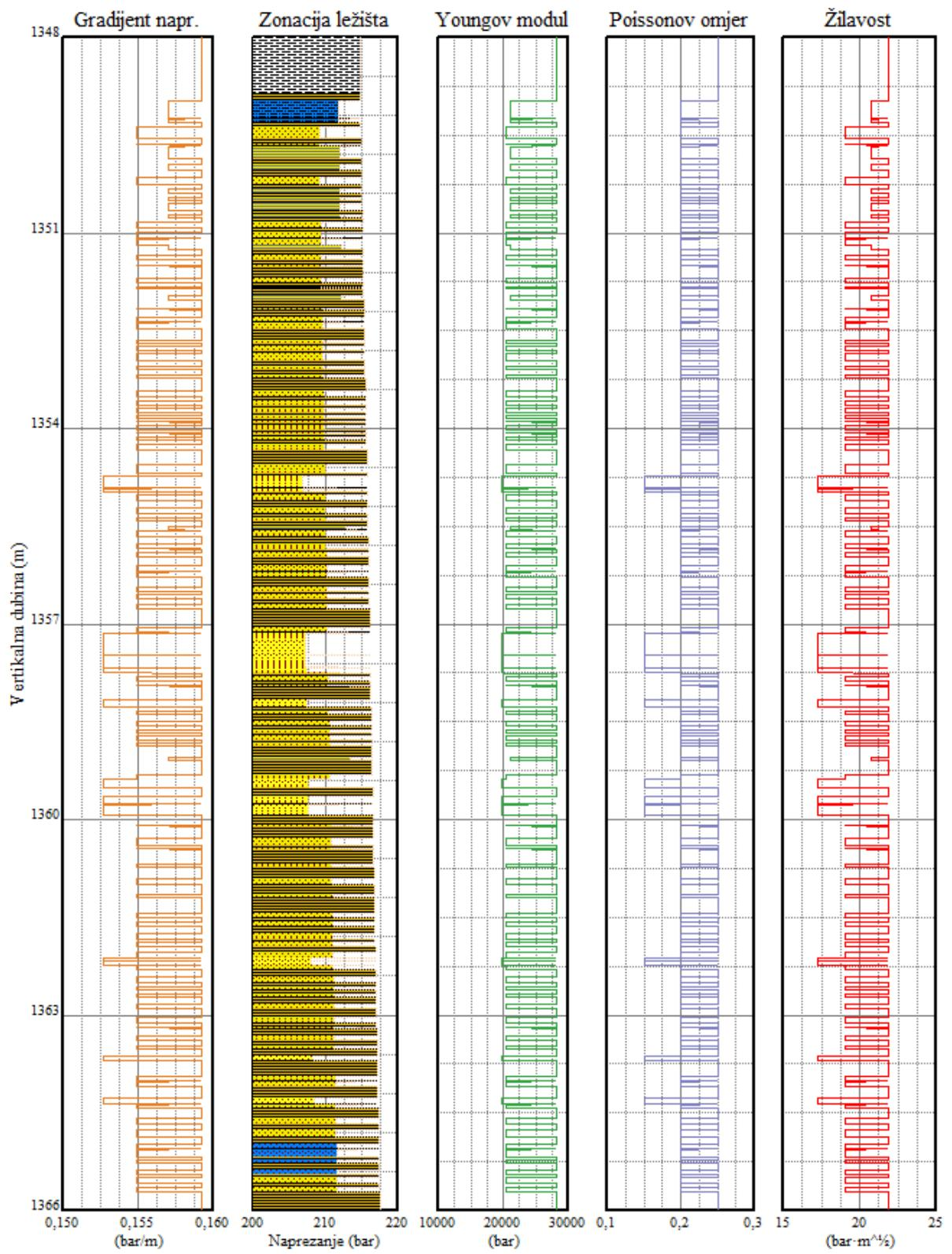
Slika 53. Mehanička svojstva u području ležišta PLQ-F bušotine SJ – 1 Dir temeljena na TLA analizi.
