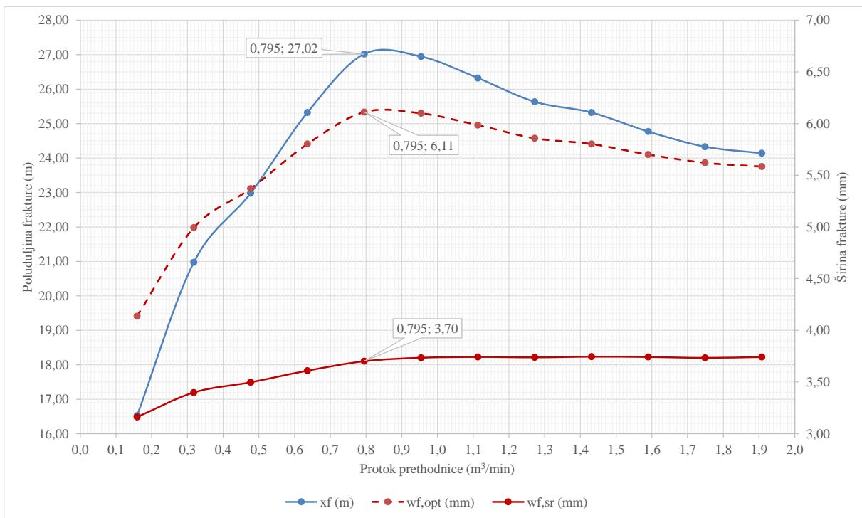
Slika 46. Zavisnost kretanja vrijednosti maksimalnih poluduljina frakture i vrijednosti srednje širine iz simulacije utiskivanja prethodnice i teoretski optimalne širine frakture ležiste PLQ-F bušotine SJ – 2 Dir.
