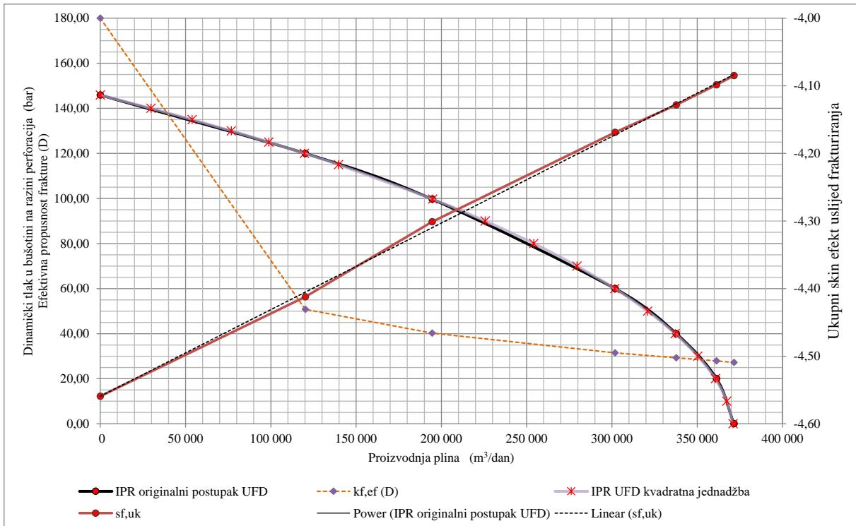
Slika 30. Indikatorska krivulja idealno frakturiranog ležišta PLQ-F istražne bušotine SJ – 1 Dir i pravac linearne regresije ovisnosti ukupnog *skin-a* uslijed frakturiranja o veličini protoka plina.
