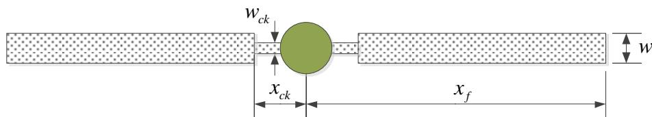
Slika 14. Model prigušene frakture (Romero et al., 2002).
