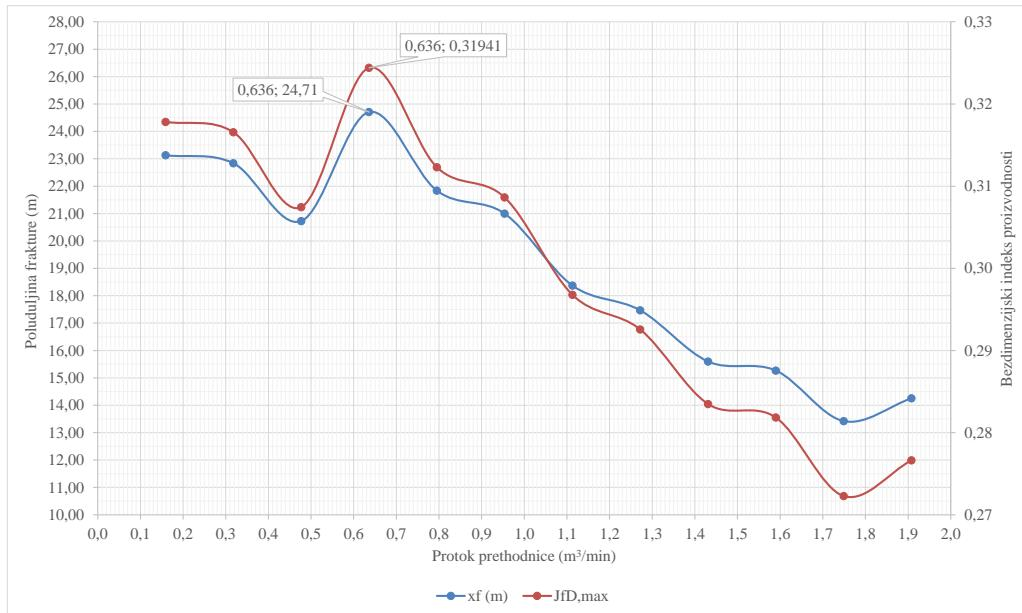
Slika 55. Zavisnost kretanja vrijednosti maksimalnih poluduljina frakture i odnosnih teoretskih maksimalnih bezdimenzijskih indeksa proizvodnosti u funkciji protoka prethodnice za ležište PLQ-F istražne bušotine SJ – 1 Dir.
