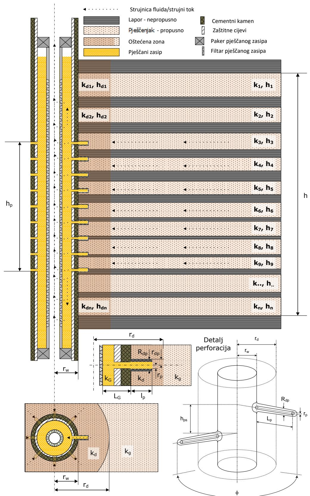
Slika 6. Model pritjecanja plina iz tanko proslojenog ležišta u konvencionalno zacjevljenu bušotinu s perforacijama opremljenu pješčanim zasipom.
