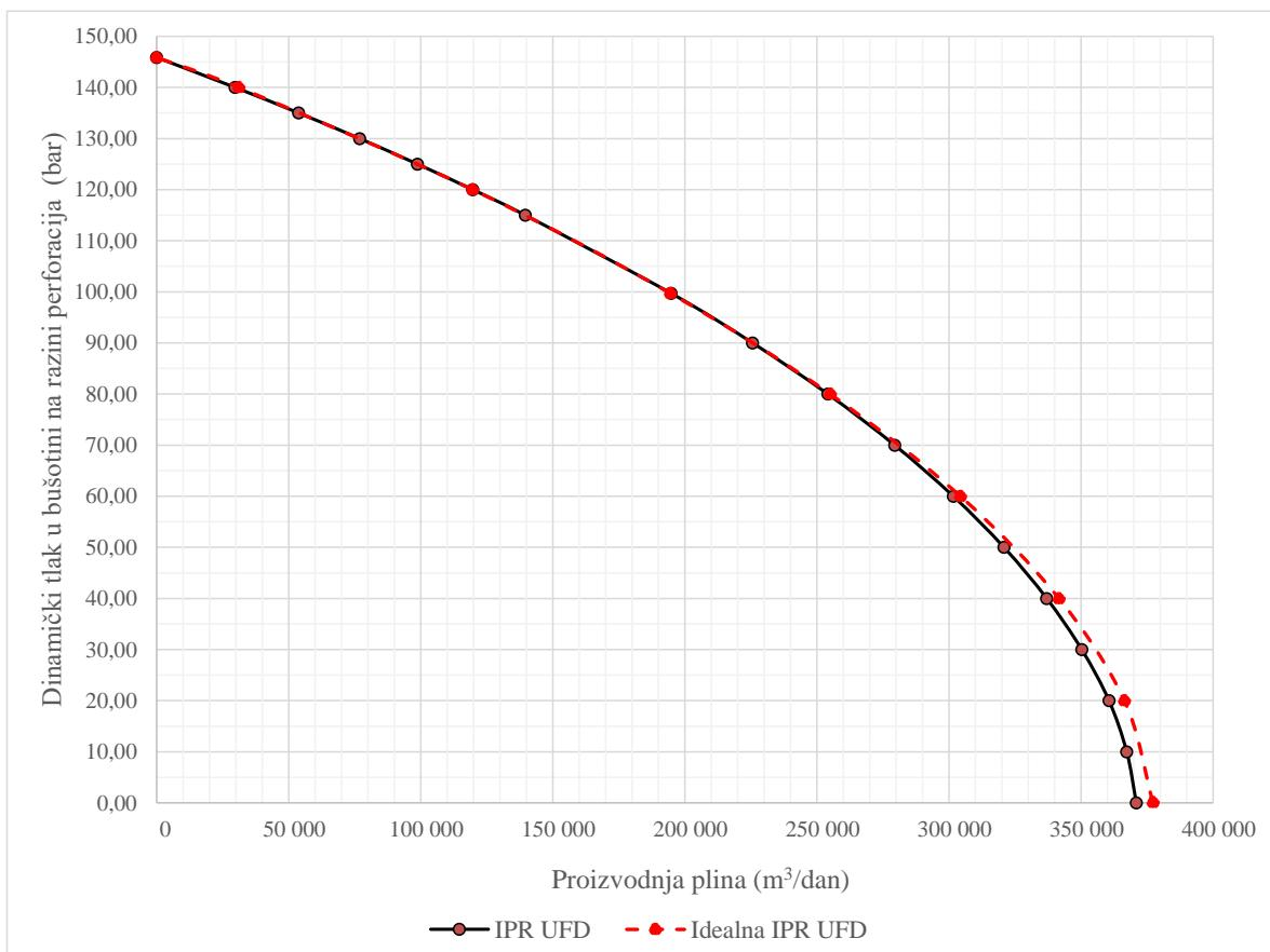
Slika 32. Komparativni prikaz idealne IPR krivulje i IPR krivulje određene teoretski optimalnom geometrijom frakture kod  $p_{wf} = 99,70$  bar istražne bušotine SJ – 1 Dir.
