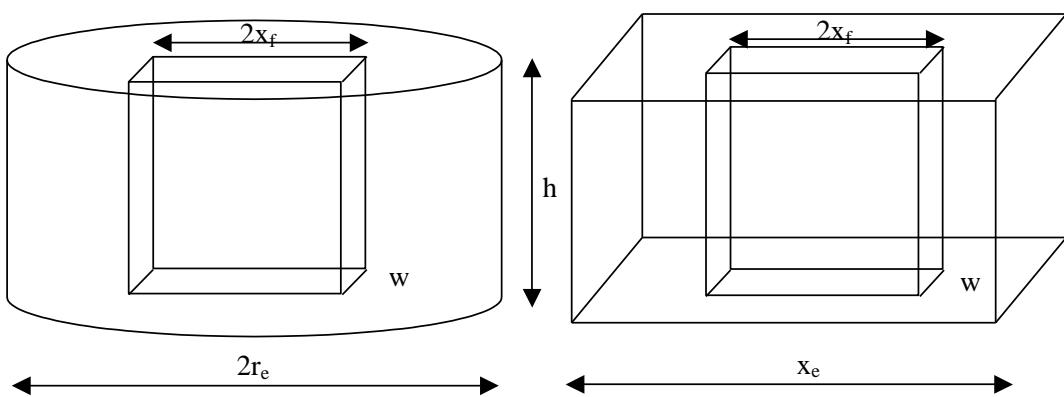
Slika 7. Model vertikalne frakture unutar kružne odnosno kvadratne drenažne površine - volumena, preuzeto iz Valko (2006).
