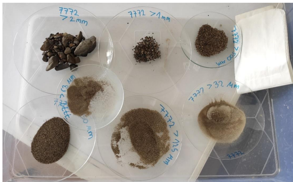
Slika 9.10. Granulometrijske frakcije čestica uzorka vodotočnog sedimenta potoka Žirovac (BEŠ-VS; na fotografiji lab. br. 7772) nakon isparavanja viška vode na vodenoj kupelji (foto: Adelita Skitarelić)
