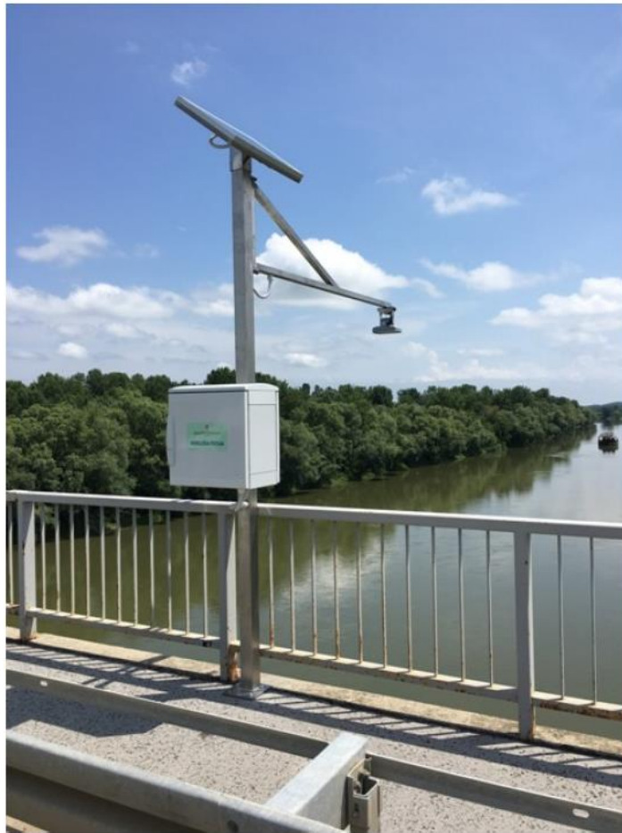
Slika 4.3. Hidrološka postaja Crnac na Savi (preuzeto s DHMZ-a)
